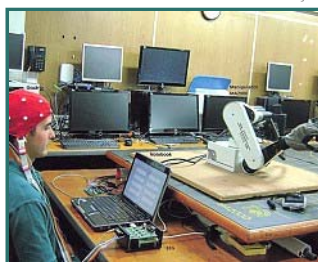
Experimento. A touca detecta a atividade cerebral através de eletrodos, e um aparelho interpreta qual é a ação desejada pelo usuário
