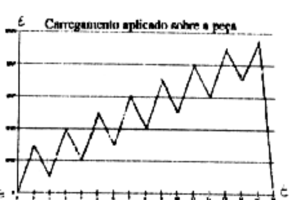
Figura 4a: Carregamento para ilustrar efeito da contagem rain-flow na carga
