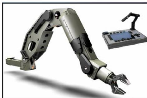
Figura 8 – Modelo do manipulador TA-40 e miniatura utilizada como “mestre” na tele-operação (Slingsby, 1998).
