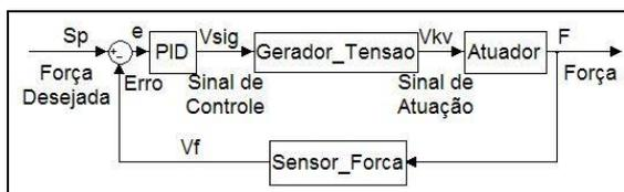
Figura 3: Diagrama de blocos do sistema de controle de força do atuador polimérico.
