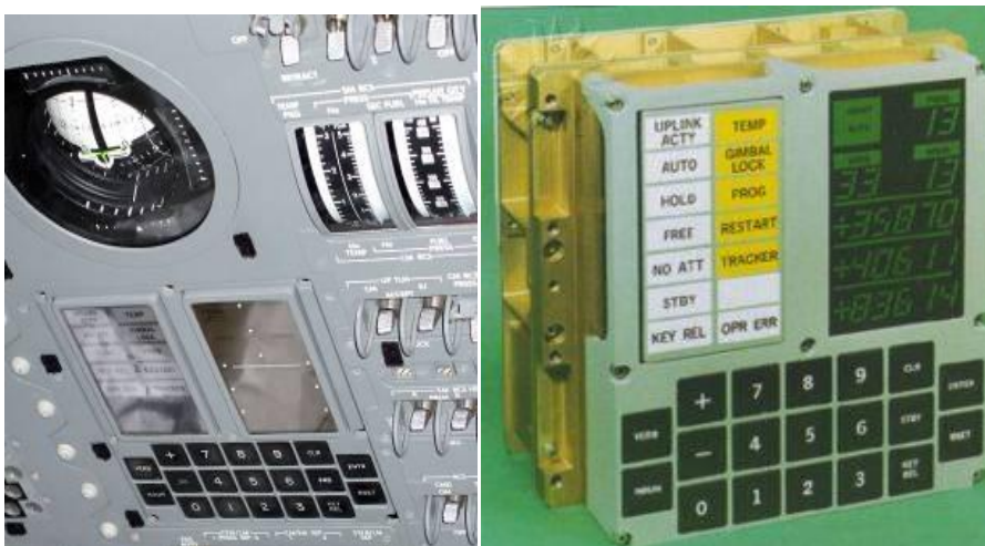
Figura 3.1: AGC instalado no painel da Apollo em laboratório. Fonte: O'BRIEN, 2010.
