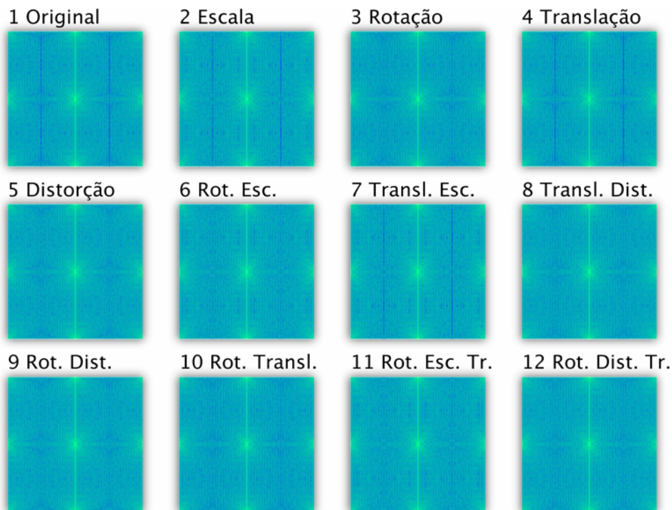
Figura 7-22: Transformadas de Fourier Mellin tipo 2 para quadrados
