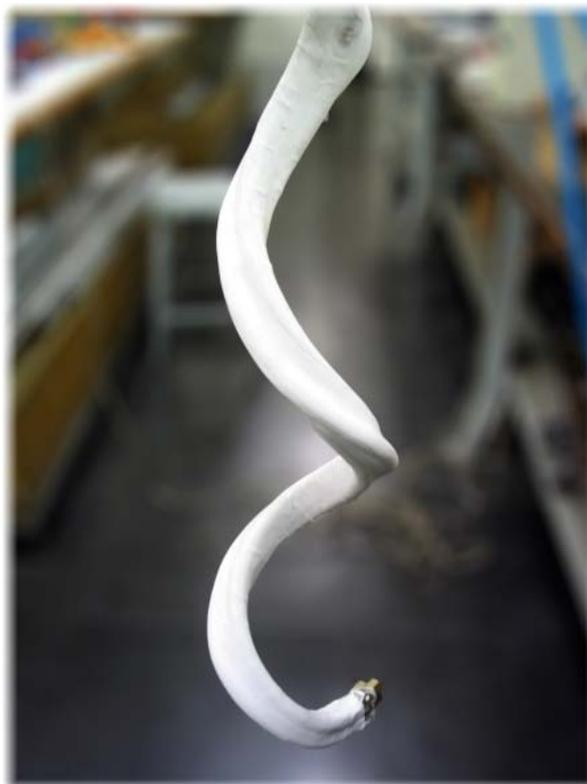
Figura 66: 3ª Geração, mangueiras de silicone reforçadas com fio de polipropileno, revestidas com cola de poliuretano
