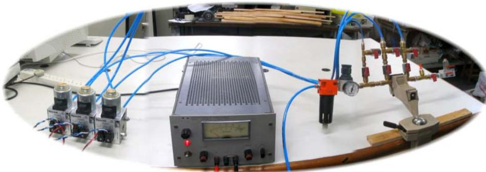
Figura 108: Equipamentos utilizados nos experimentos (da esquerda para a direita – servoválvulas, fonte de alimentação e o sistema manual de válvulas)
