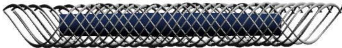
Figura 14: Tubo reforçado com malha de fibras trançadas
