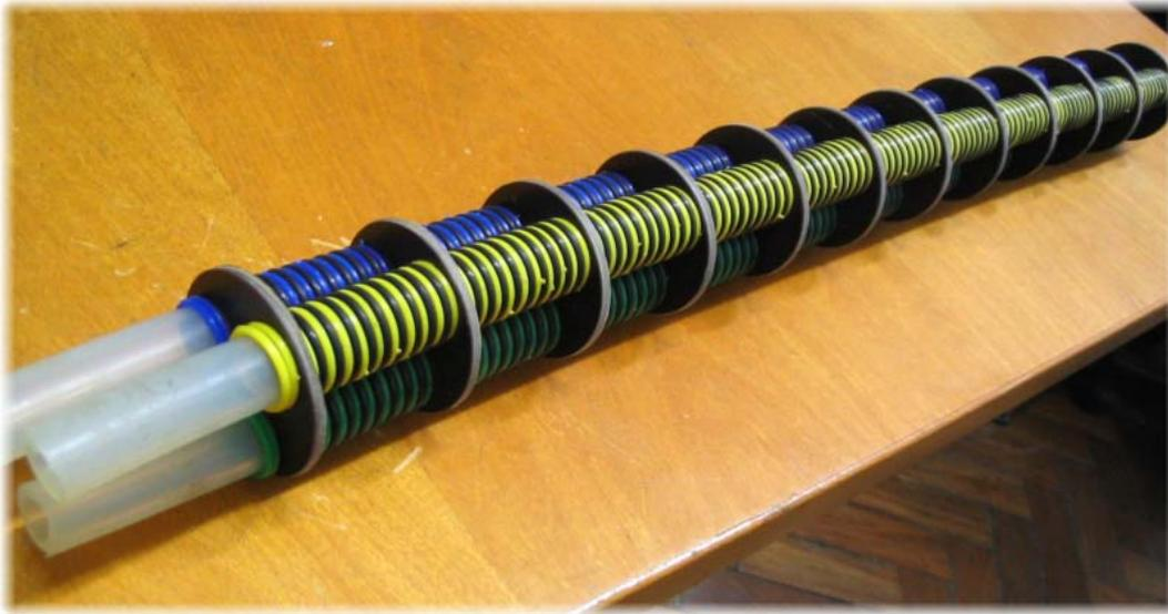
Figura 72: 4ª Geração, mangueiras de silicone reforçadas com anéis flexíveis e rígidos, agrupadas com espaçadores de Fenolite
