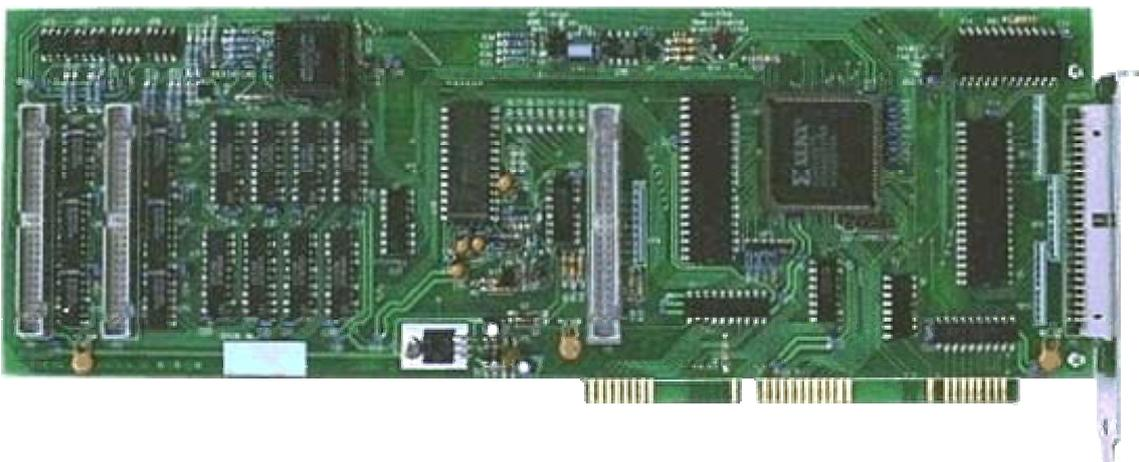
Figura 105: Placa *ISA Bus Servo I/O Card* utilizada nos experimentos
