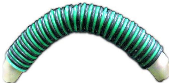
Figura 49: Anéis rígidos e flexíveis durante a curvatura da mangueira
