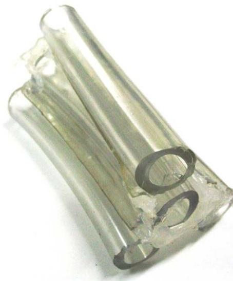
Figura 77: Amostra do espaçador feito de mangueiras siliconadas
