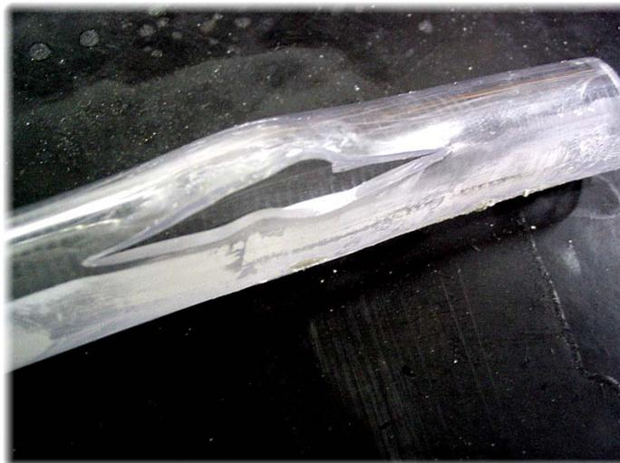
Figura 34: Ruptura da mangueira de silicone pelo excesso de pressão aplicada
