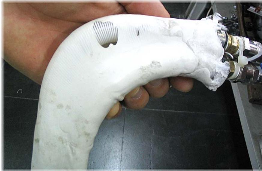
Figura 67: Rompimento da cola de poliuretano devido à força exercida pelos músculos
