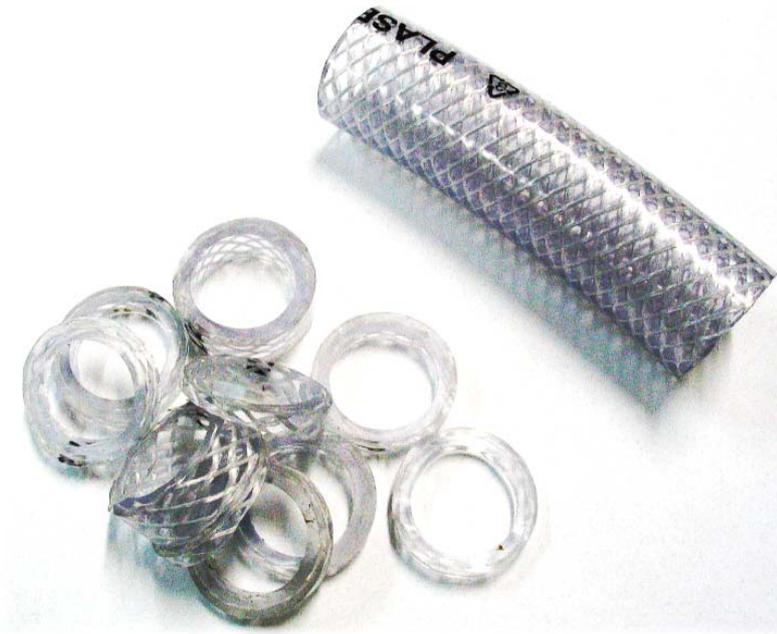
Figura 43: Anéis cortados a partir de uma mangueira rígida reforçada com fibras
