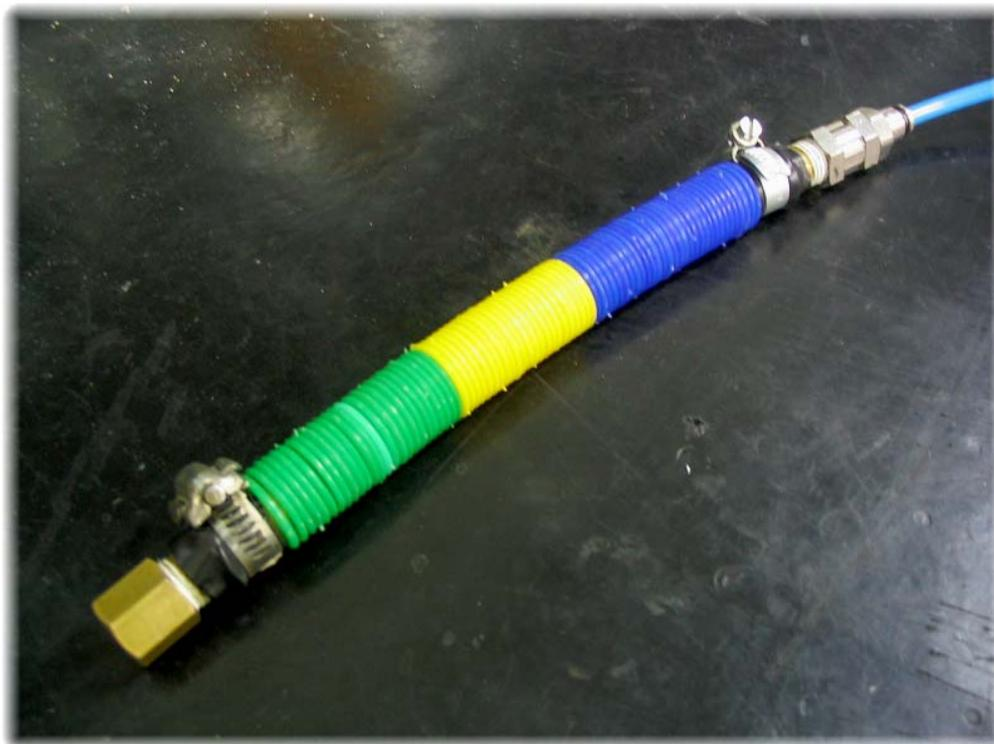
Figura 46: Mangueira de silicone montada com anéis rígidos
