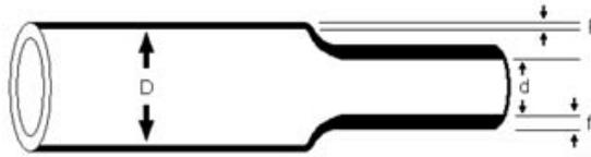
Figura 89: Dimensões do termo retrátil
