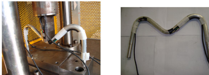
Figura 78 – Estrutura em “U” após impacto a 19,44 km/h. Fonte: Nuclep S/A.
