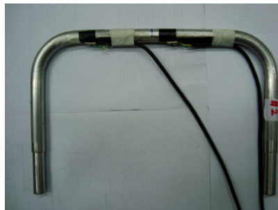
Figura 54 – Pórtico em “U” instrumentado com extensômetro. Fonte: PUC-RJ.
