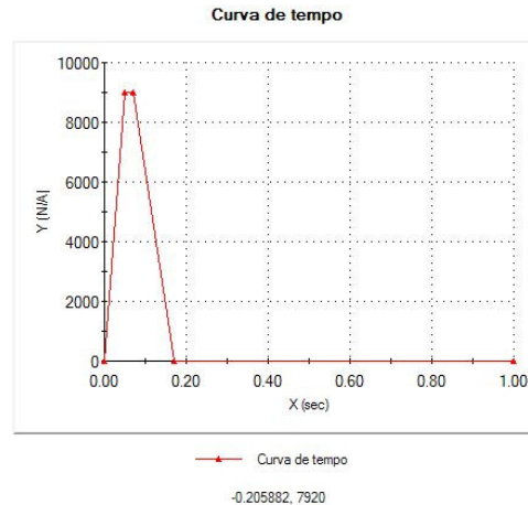
Figura 61 – Duração e Amplitude de impacto. Fonte: Programa CosmosWorks Advanced Professional 2006 .
