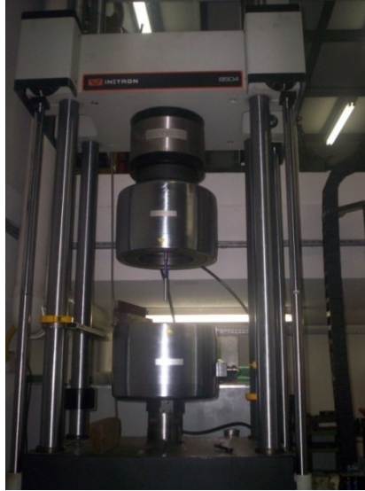
Figura 38 - Máquina universal para ensaio de tração. Fonte: ITUC – PUC-RJ.
