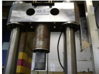
Figura 46 – Massa de 48,3 kg e colunas guias da máquina de queda de peso. Fonte: Nuclep S.A
