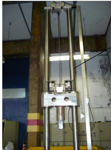
Figura 46 – Massa de 48,3 kg e colunas guias da máquina de queda de peso. Fonte: Nuclep S.A
