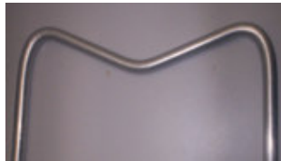
Figura 55 – Estrutura deformada após colisão com massa de 48,3kg.
