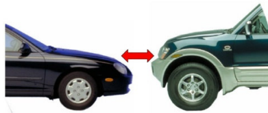
Figura 19 – Diferença de altura dos elementos absorvedores de energia nos veículos.
