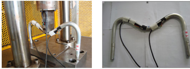
Figura 71 – Estrutura em “U” após impacto a 15,84 km/h. Fonte: Nuclep S/A
