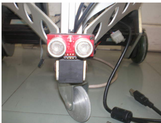
Figura 3.5: Sensor de Ultra-Som SRF08
