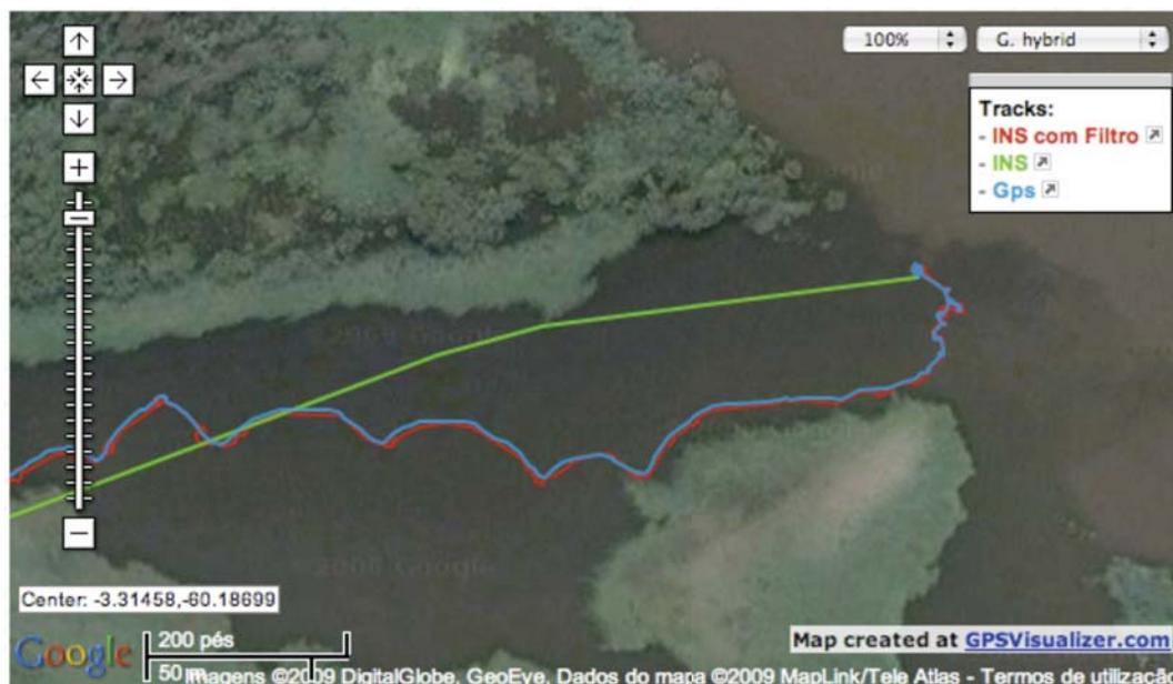
Figura 10 – Corte 1 da Ampliação do Mapa Geo-Referenciado das posições do Filtro de Kalman, do INS e do GPS nos testes na Amazônia
