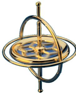
Figura 12 – Girômetro Mecânico.
