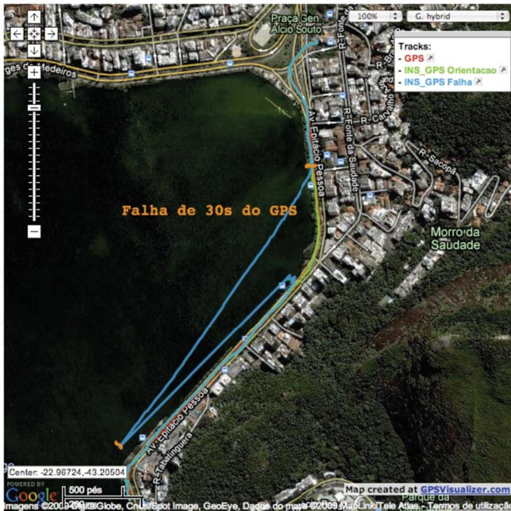
Figura 18 –Mapa da Falha do Sinal do GPS no Experimento na Lagoa.
