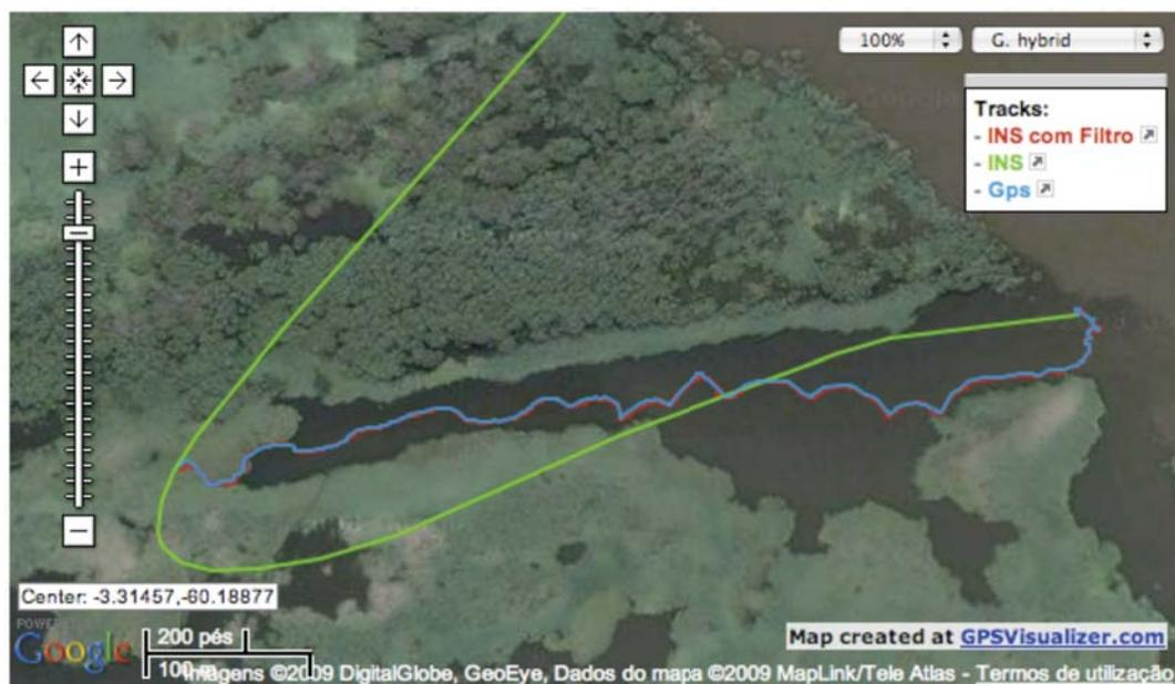
Figura 9 – Zoom do Mapa Geo-Referenciado das posições do Filtro de Kalman, do INS e do GPS nos testes na Amazônia
