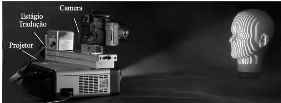
Figura 18 – Padrão estruturado de luz para triangulação em 2 dimensões, (RAMAMOORTHY et. al.)
