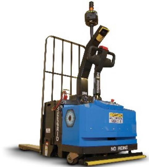
Figura 1 - Robô GP8 da Seegrid.
