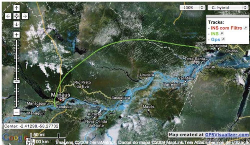
Figura 8 – Mapa Geo-Referenciado das posições do Filtro de Kalman, do INS e do GPS nos testes na Amazônia.
