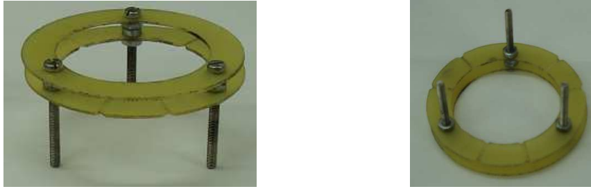
Figura 93: Anéis Fixadores separados 5 mm com ajuda de parafusos.
