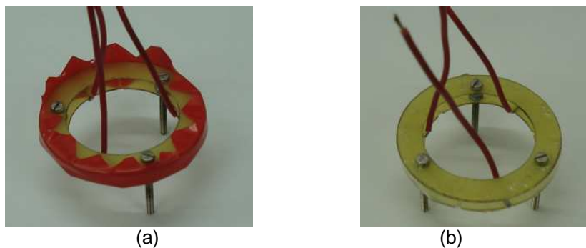
Figura 95: (a) Superfície cortada para evitar acumulação de material. (b) Músculo colado aos fixadores, pronto para ser esticado.
