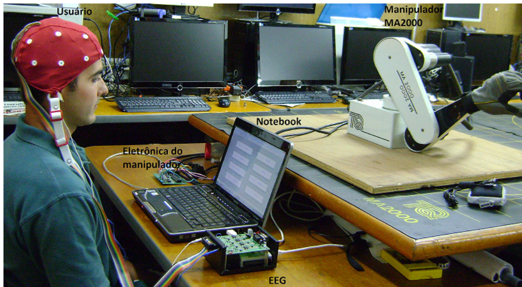
Figura 56 - Experimento com a interface para controle do manipulador.
