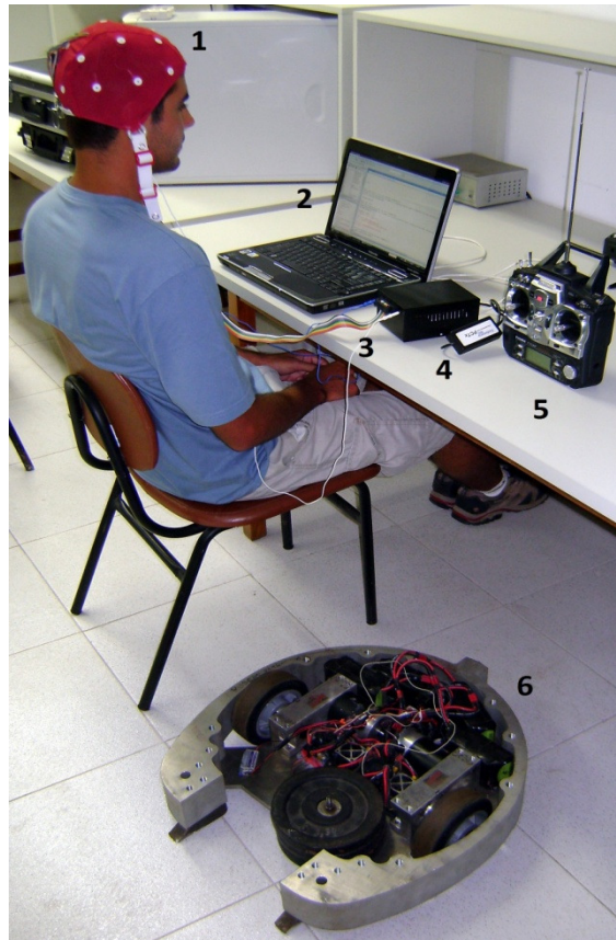
Figura 57 - Experimento com o robô móvel: 1- Eletrodos; 2- Computador; 3- EEG; 4-PCTx Link; 5-Transmissor RF; 6-Robô móvel.
