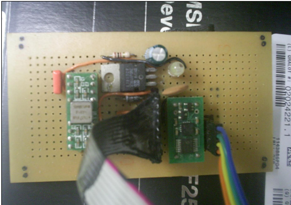
Figura 45: Placa onde foram montados os sensores. No lado esquerdo aparece o girômetro, e no lado direito o acelerômetro.
