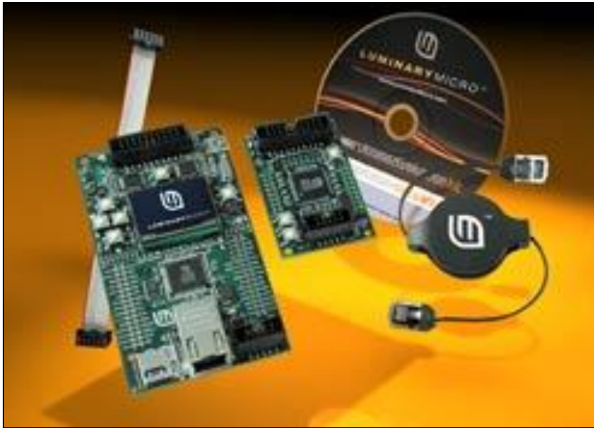
Figura 49: Kit de controle LM3S8962, utilizado como controlador do TPRE
