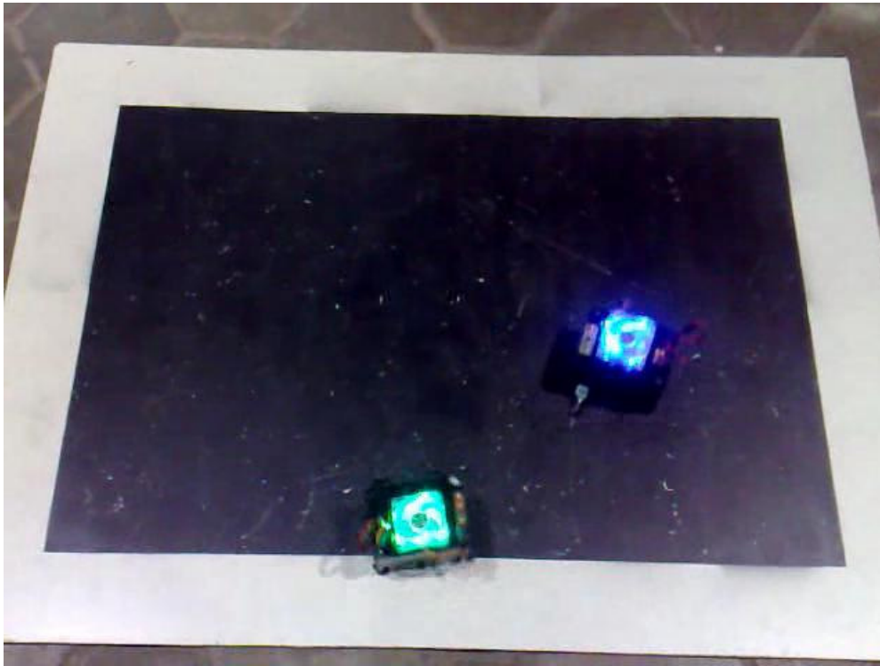
Figura 57 – Robô predador, em verde, e robô presa, em azul, na arena.
