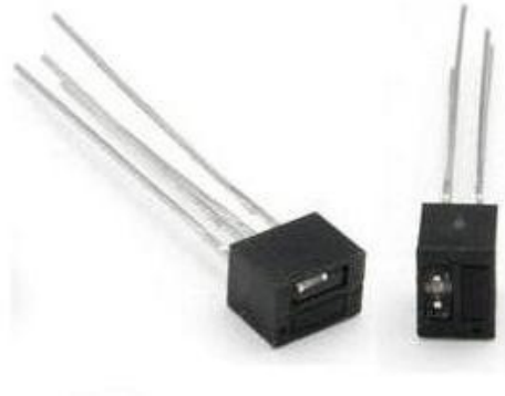
Figura 35 – Sensor infravermelho utilizado. QRD1114 – FairChild Semiconductors . [19]
