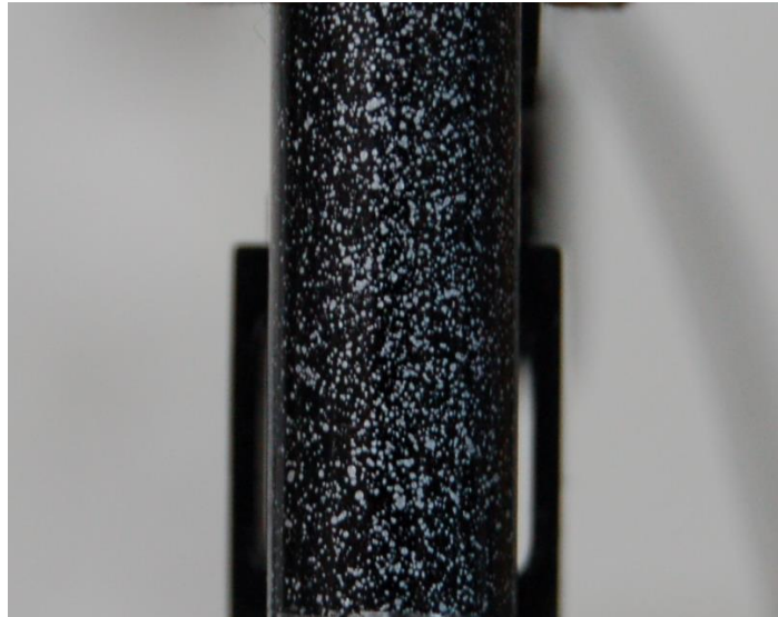
Figura 7.2 Montagem experimental do corpo de prova cilíndrico de alumínio.
