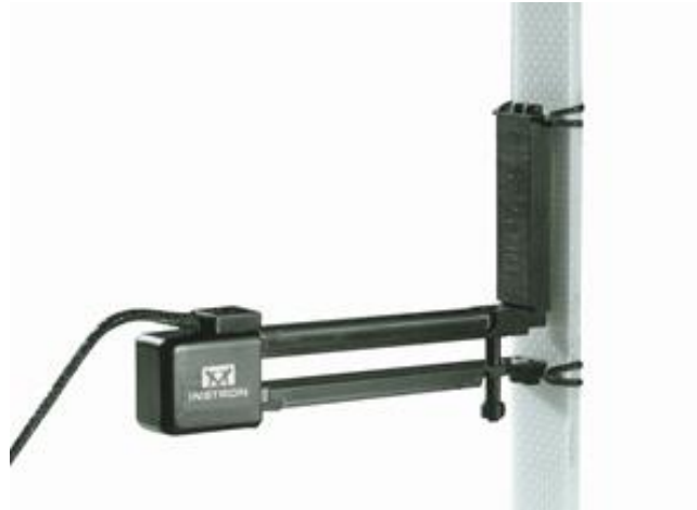
Figura 7.1 Extensômetro Instron montado no corpo de prova.
