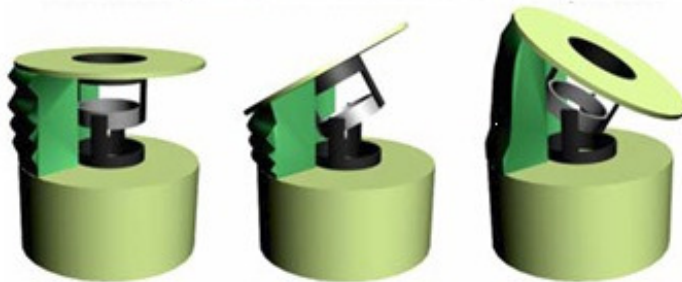
Figura 6 – Estrutura Baseada em Juntas Pneumáticas
