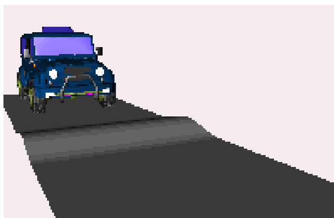
Figura 6 – Universal Mechanisms simulando a dinâmica de um utilitário sobre uma lombada [12]
