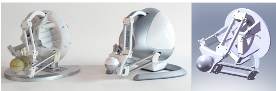
Figura 5.4: Modelo CAD do Novint Falcon ®
