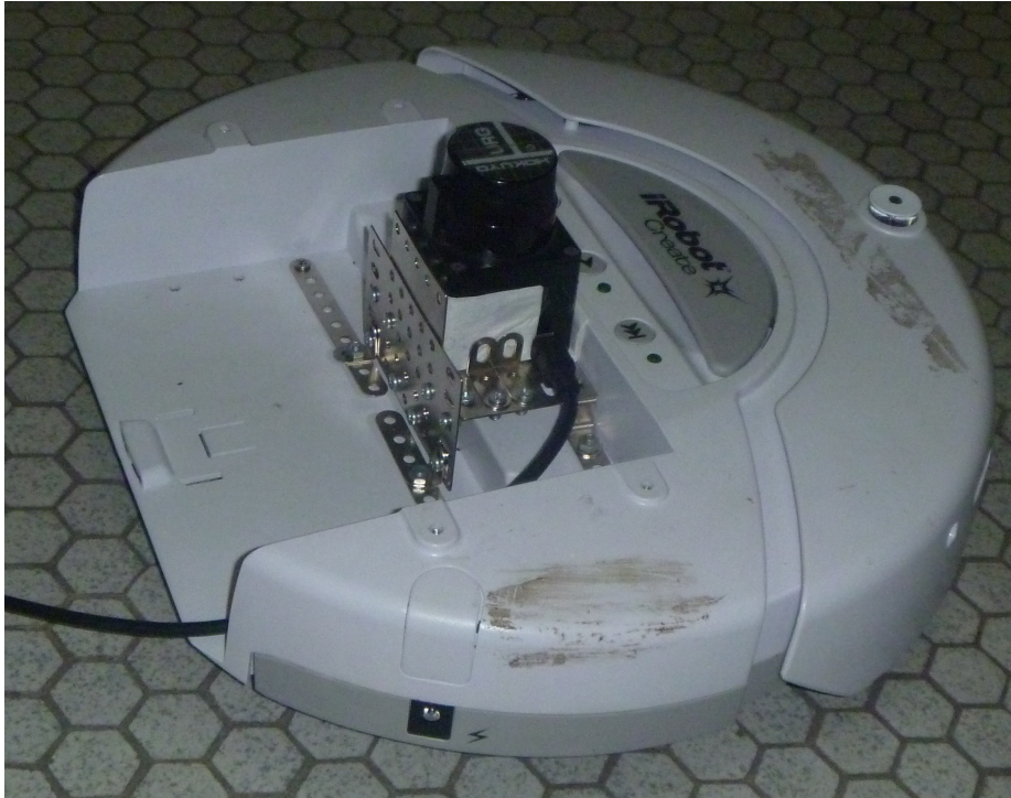
Figura 90: O Robô iRobot Create acoplado a um LRF ( URG – 04LX – UG01 )
