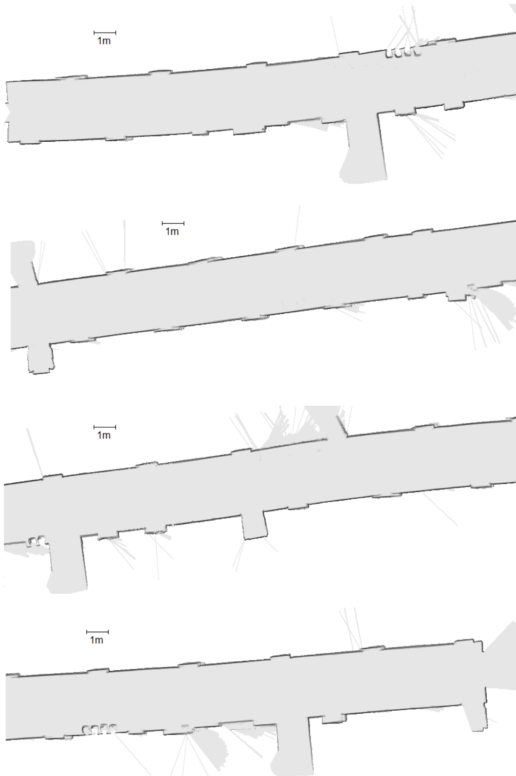
Figura 211: Detalhes do Mapa 2D do ambiente da segunda experiência obtido usando o algoritmo DP-SLAM
