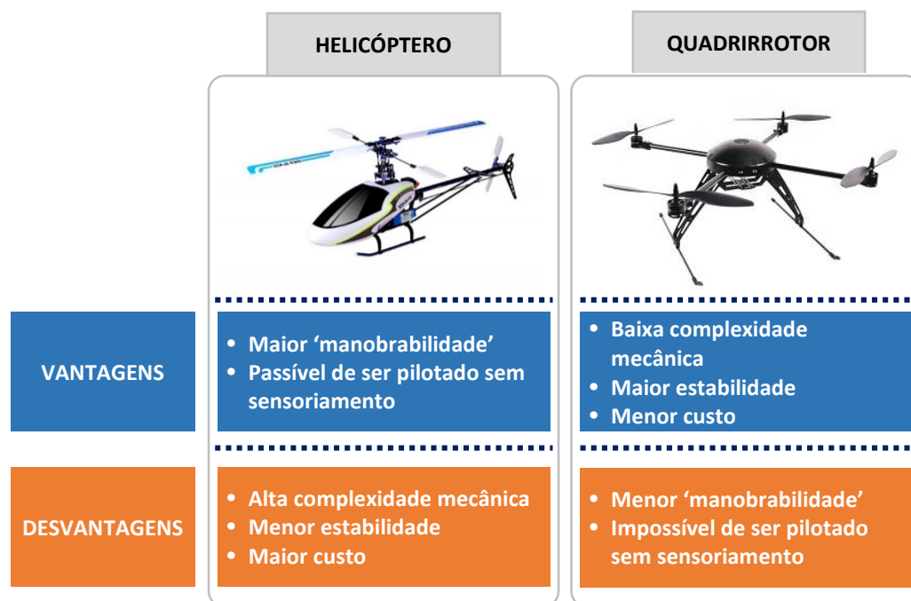
Figura 1.1: Quadro comparativo entre o helicóptero e o quadricóptero.
