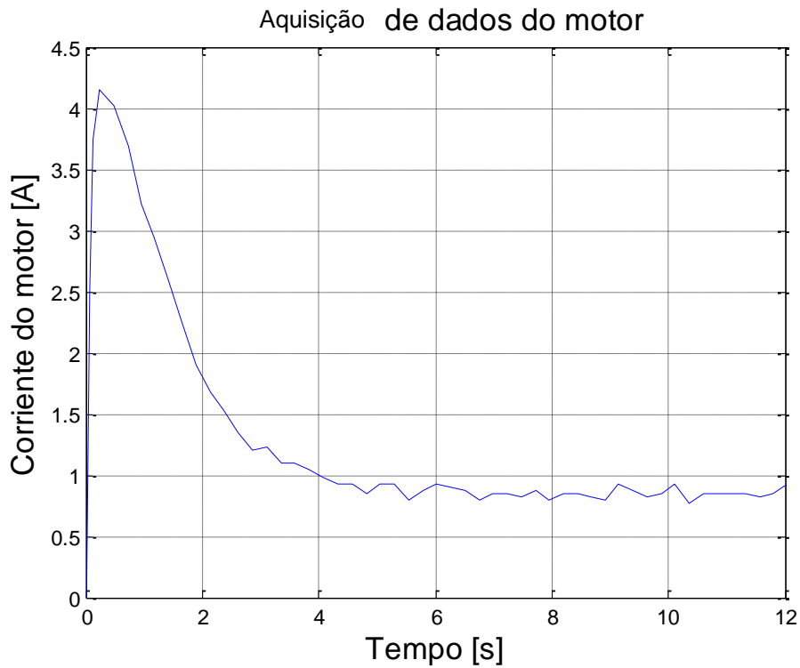
Figura 51 Corrente do motor para resposta em degrau.
