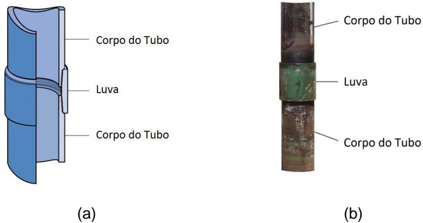
Figura 23 - Juntas de revestimento unidas pelo conector: (a) esquemático e (b) foto.
