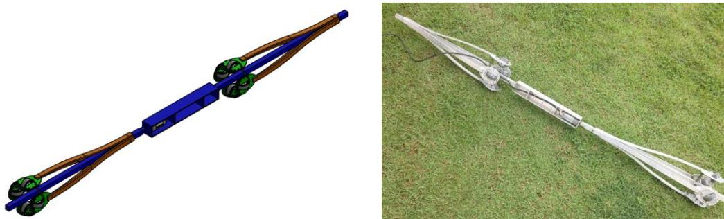
Figura 52 - Robô utilizado nos testes dos sistemas de deslocamento e posicionamento
