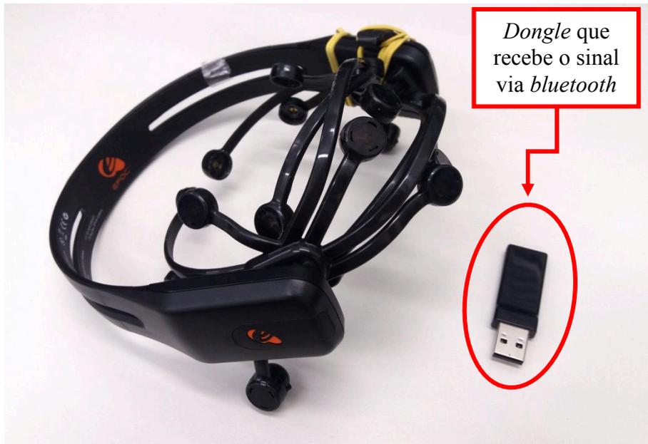
**Figura 35 - Aparelho de EEG utilizado, Emotiv EPOC.**
