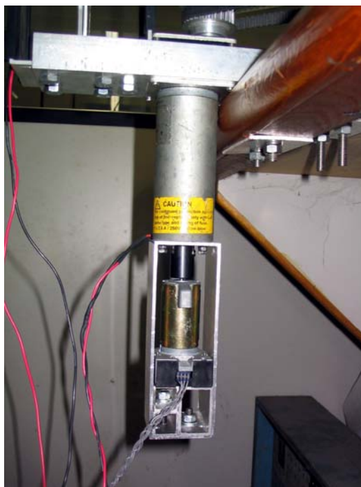
Figura 5 – Acoplamento do motoredutor (acima) com o tacômetro/encoder (abaixo, dourado).
