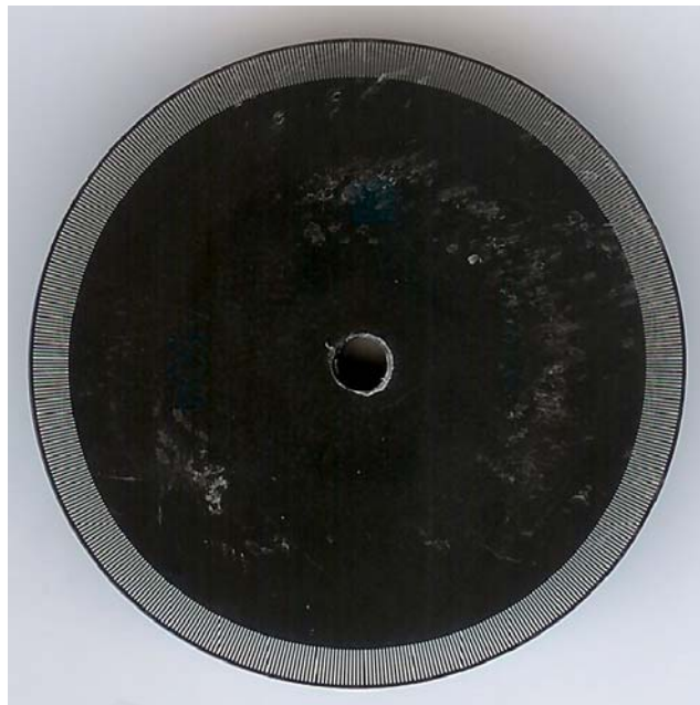
Figura 4 - Disco óptico do encoder de alta resolução utilizado.
