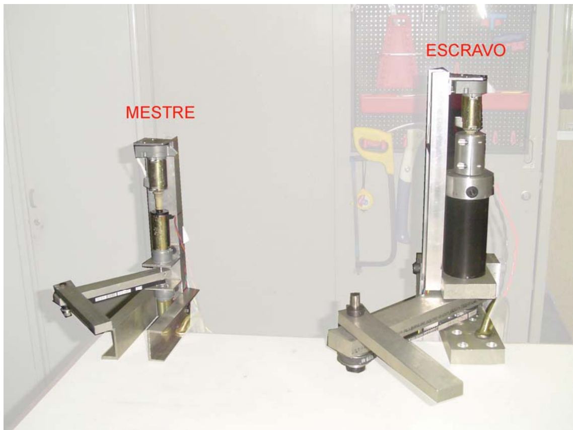
Figura 3: Foto dos dois manipuladores montados em suas posições finais
