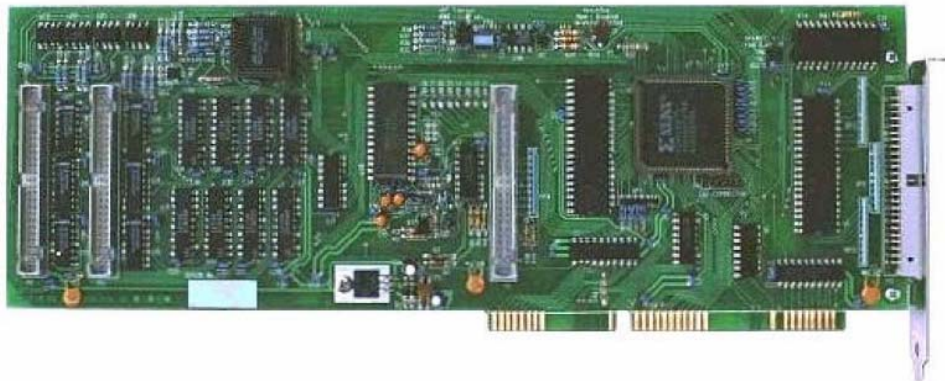
Figura 8: Placa A/D D/A utilizada como interface sensores-software
