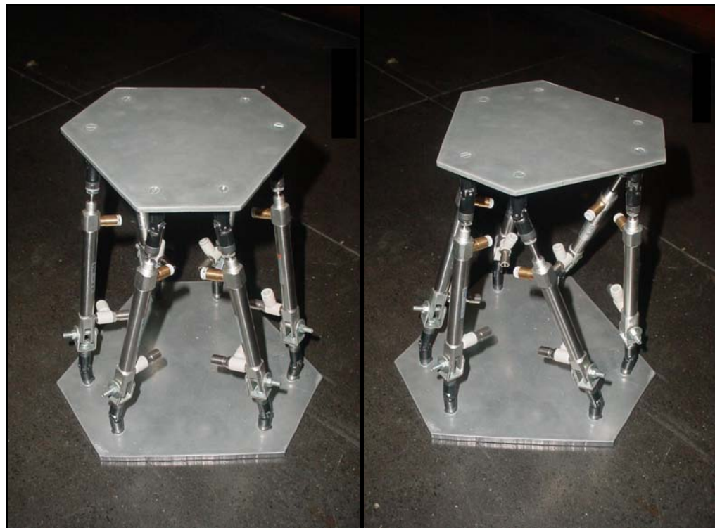
Figura 4.2 Plataforma Stewart construída.
