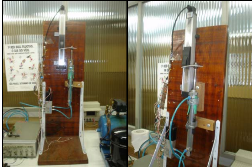
Figura 3.1 Conjunto válvula-atuador pneumático-transdutor já desenvolvido.
