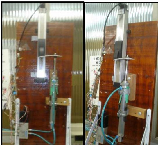
Figura 3.1: Conjunto válvula-atuador pneumático-transdutor já desenvolvido.
