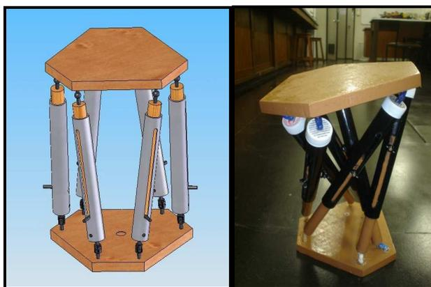
**Figura 3.2: Protótipo virtual e protótipo da Plataforma Stewart construído.**
