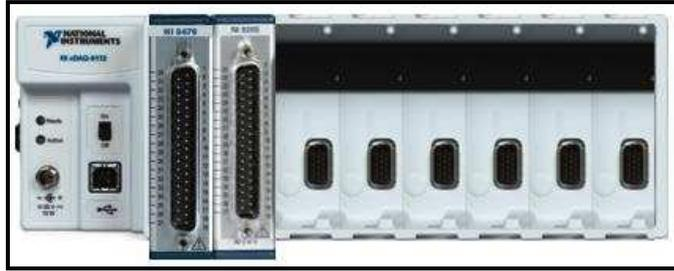
Figura 3.19: Chassi do sistema de aquisição/emissão de dados.
