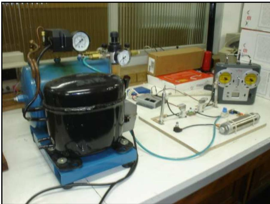
Figura 7.1: Bancada de testes do sistema de atuadores pneumáticos [8].
