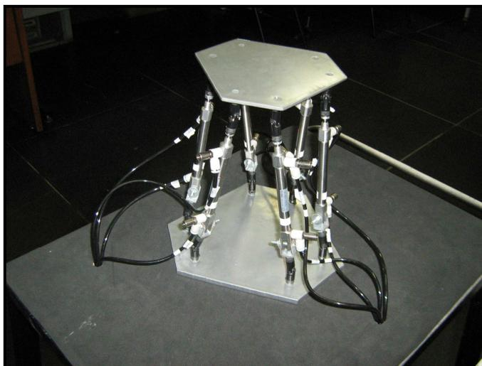
**Figura 3.21: Plataforma Stewart construída.**
