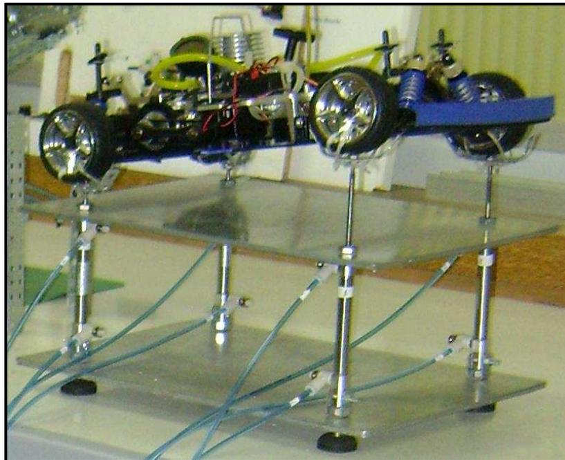
**Figura 7.3: Simulador Vertical construído.**
