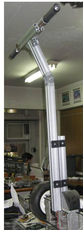
**Figura 4.** Haste vertical com reguladores de altura e inclinação
