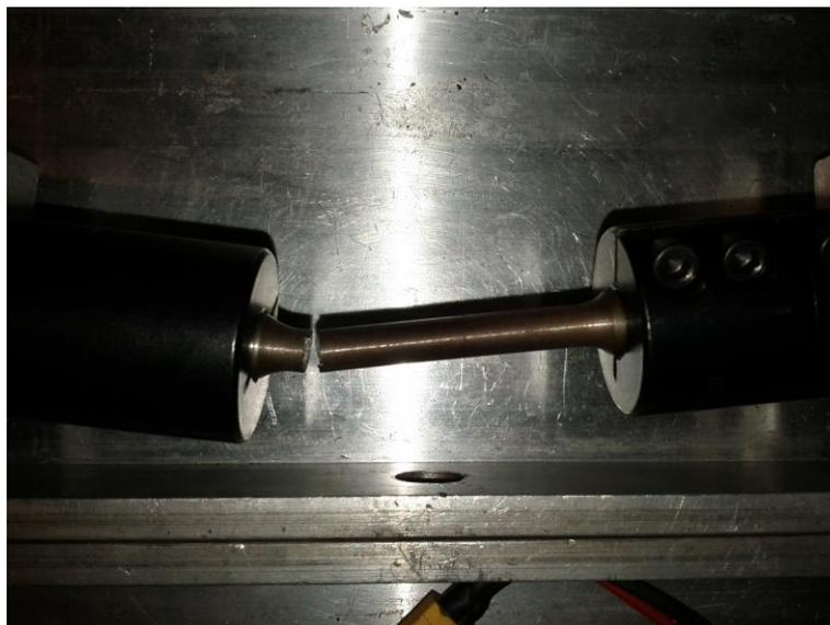
Figura 17: Corpo de prova de aço 1045 de 1/4" após 3 minutos rodando a 20.000 rpm com momento fletor considerável aplicado sobre ele. Como a seção de menor área estava muito longa nessa amostra, a ruptura não foi no centro, foi perto de um dos filetes laterais, onde houve concentração das tensões aplicadas.
