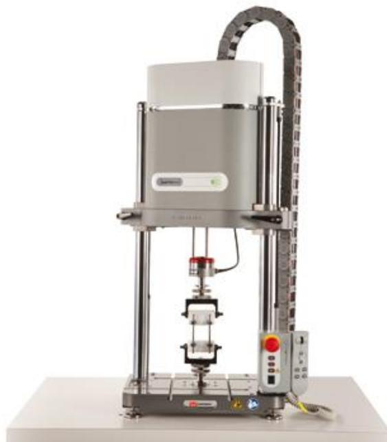
Figura 2.11. Máquina elétrica de ensaios de Fadiga ElectroPlus [INSTRON, 2010]
