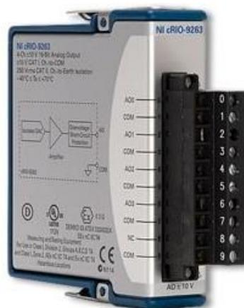
Figura 4.14. Módulo de saídas [National Instruments, 2010].
