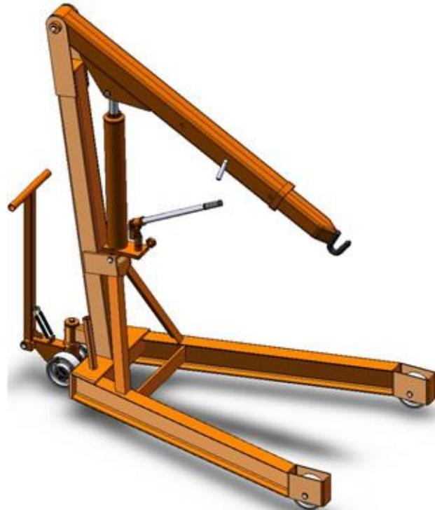
Figura 2.1. Sistema hidráulico (guincho)
