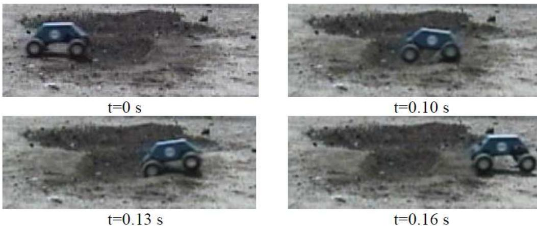
Figura 6: Sequência de fotos de um veículo robótico em alta velocidade perdendo o contato com o terreno ao passar por um buraco (8).
