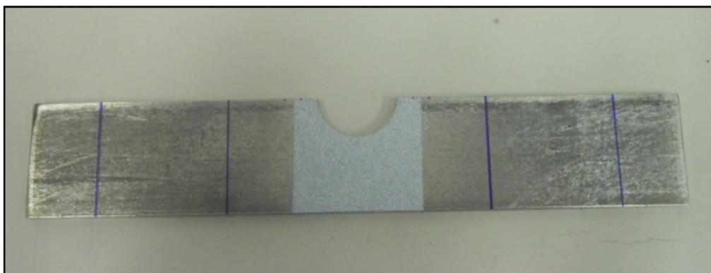
**Figura 6.7 Corpo de prova utilizado no ensaio de flexão em quatro pontos.**
