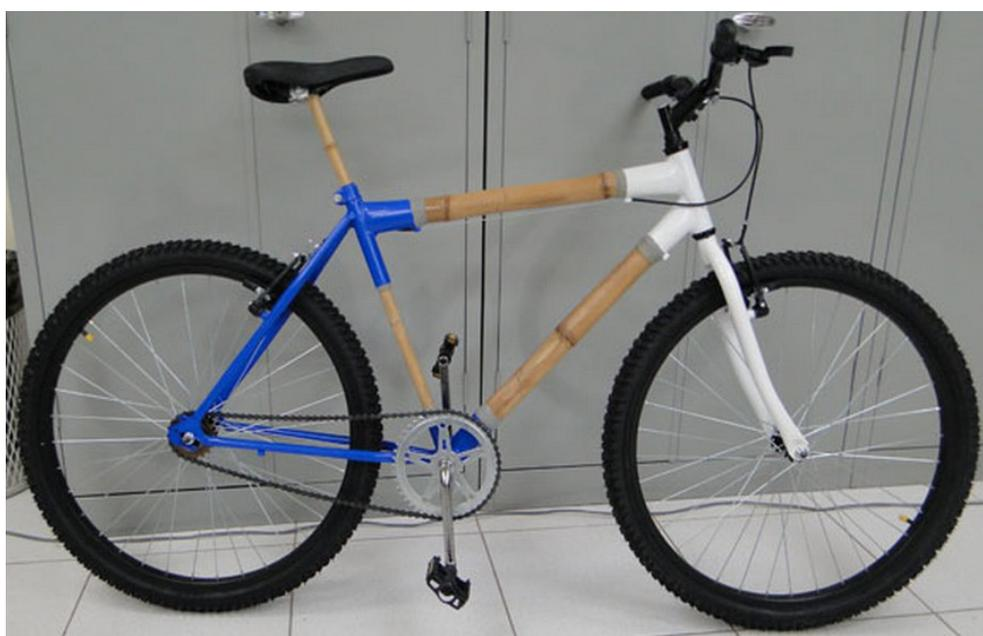
**Figura 6.1 – bicicleta com partes em bambu - Fonte: Elaborada pelo autor**
