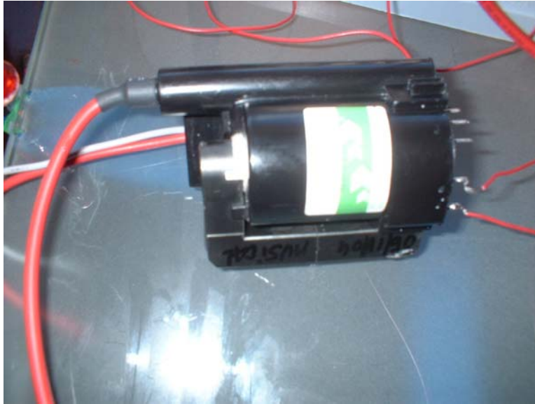
Figura 15: Flyback OV2076/M utilizado no projeto.
