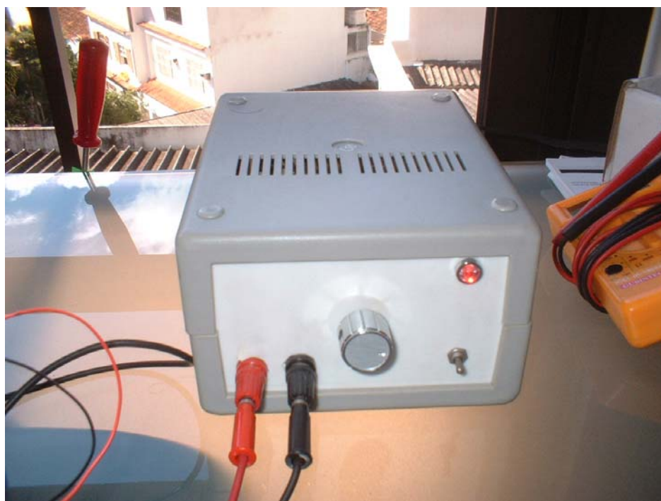
Figura 5: Fonte 30V DC utilizada.
