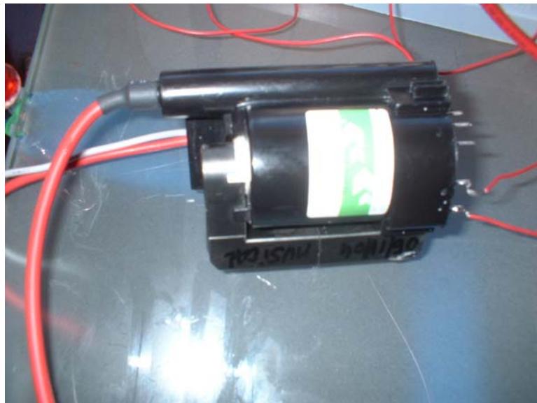
Figura 23: Flyback OV2076/M utilizado no projeto
