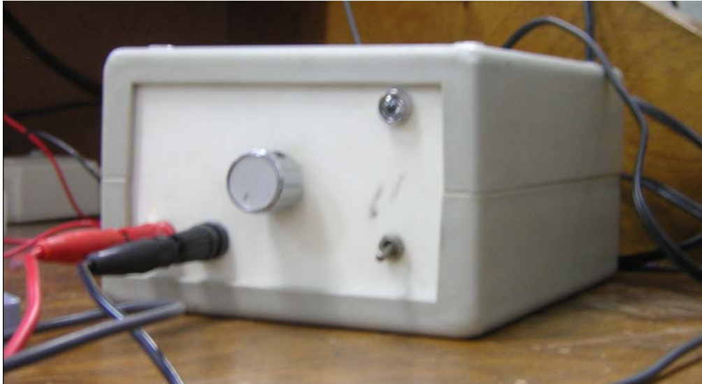
Figura 12: Fonte 30V DC utilizada
