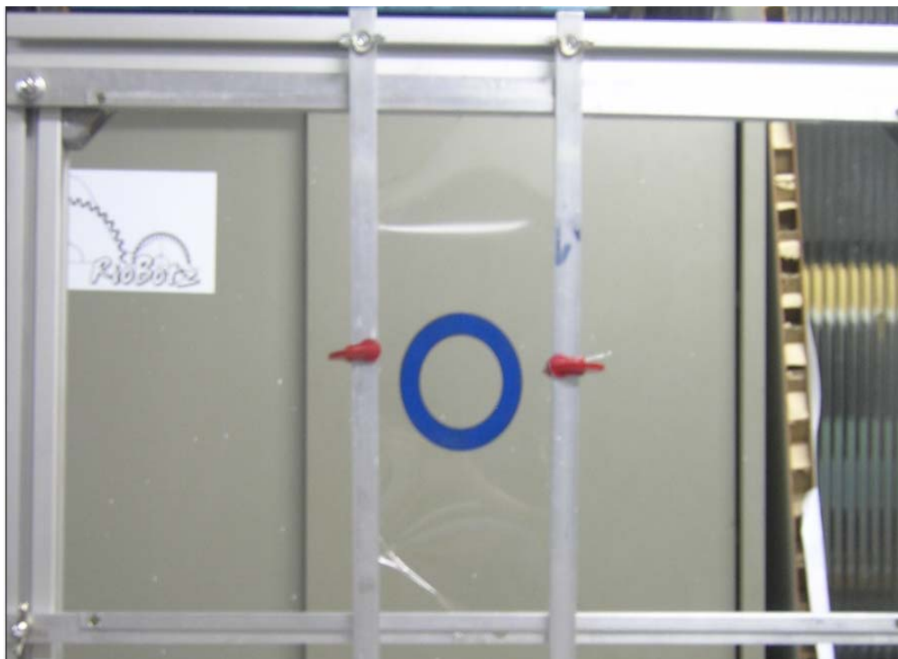
Figura 24: Polímero sendo pré-tensionado na mesa xy de apoio
