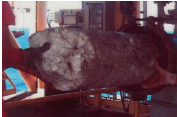
Figura 1 -- Chegada de um plugue de hidrato no lançador de Pigs
