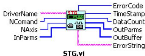
Figura 20 - Vi específica da placa ServoToGo
