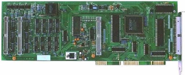
Figura 16 – Placa conversora A/D D/A
