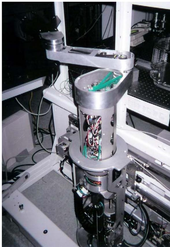
**Figura 1.2 – Visão interna de um manipulador de 2 graus de liberdade (Brooks Automation)**
