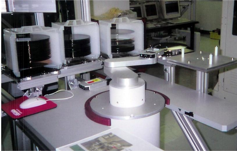
**Figura 1.1 – Manipulador de 2 graus de liberdade (Brooks Automation)**
