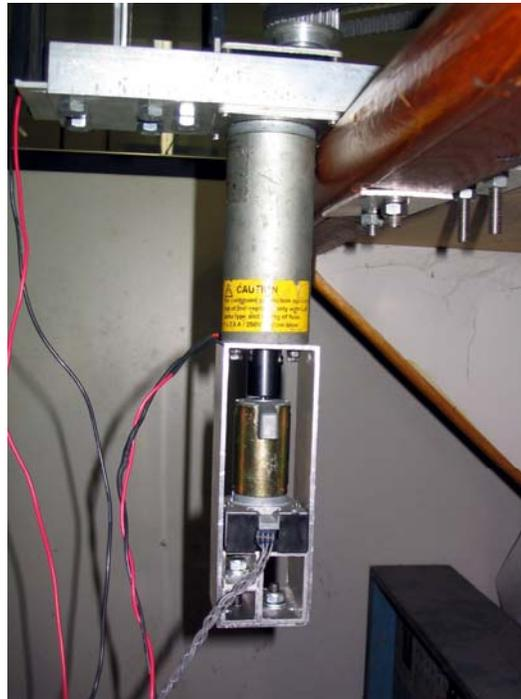
**Figura 3.3 – Acoplamento do motoredutor (acima) com o tacômetro/encoder (abaixo, dourado).**
