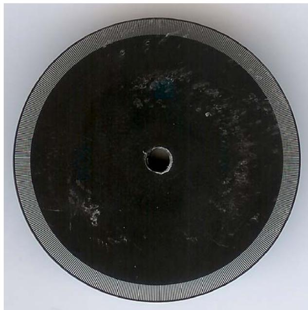
**Figura 3.2 - Disco óptico do encoder de alta resolução utilizado.**
