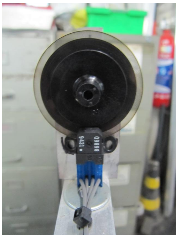
Figura 40- O posicionamento do encoder e o disco na extremidade da haste
