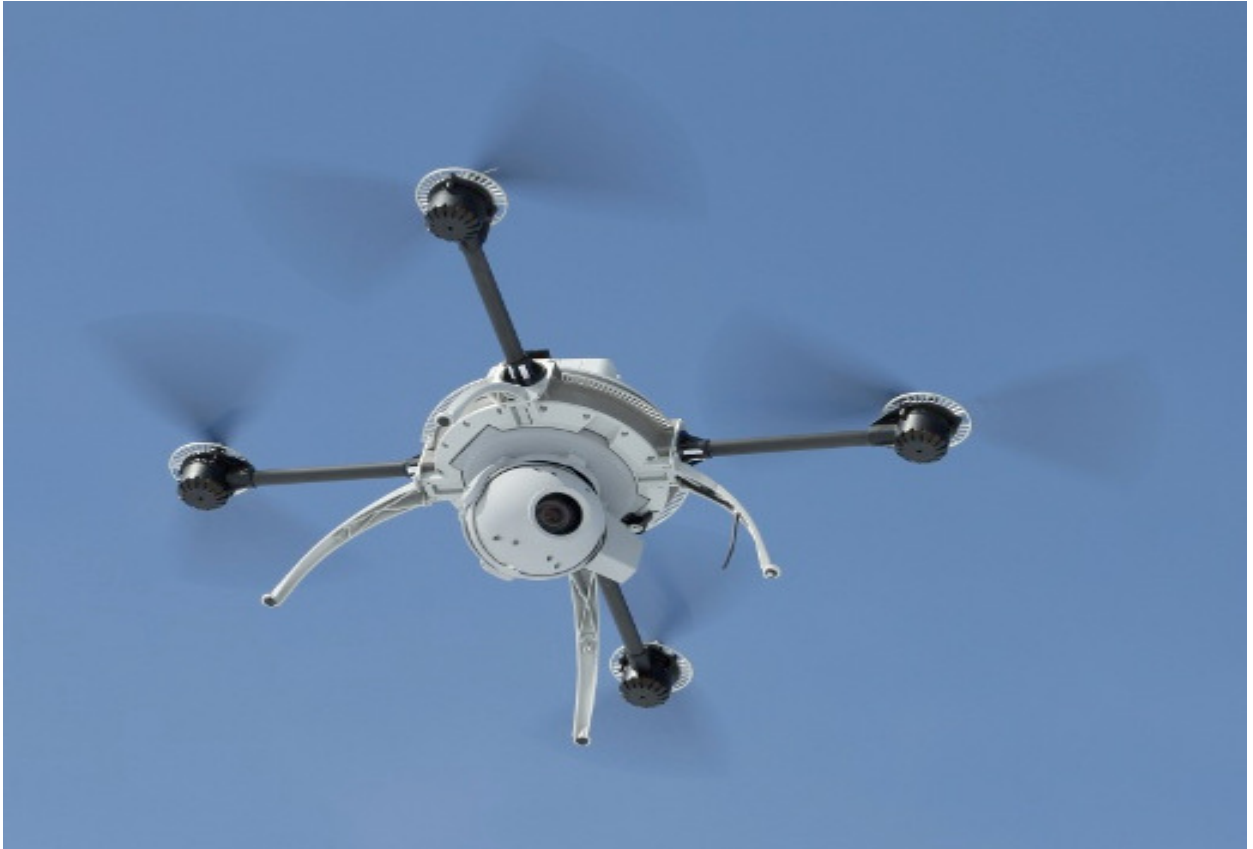
Figura 3 - Aeryon scout, produzido pela empresa canadense Aeryon labs, conta com uma poderosa câmera com zoom óptico de 10x, e uma câmera térmica utilizada para obter imagens noturnas. Pode atingir velocidades de até 50Km/h e persistir em uma posição estável mesmo em condições de ventos de até 80Km/h.
