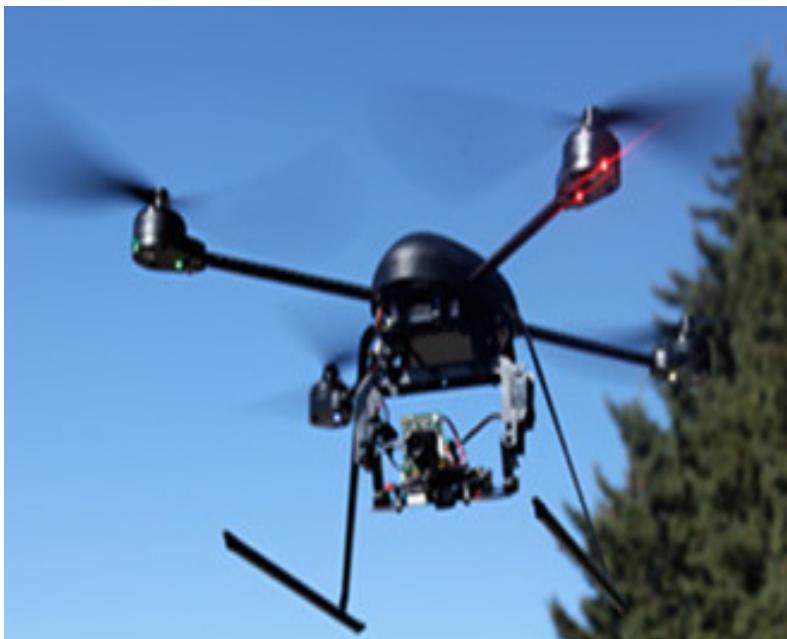
Figura 5 – Dranganflyer Possui uma IMU com acelerómetros e giroscópios, de 3 eixos.
