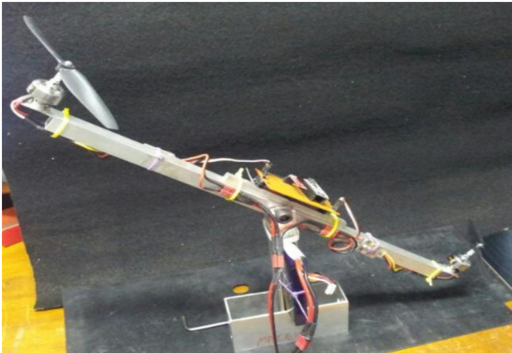
Figura 23– Protótipo montado para simular estabilidade de um multirotor.
