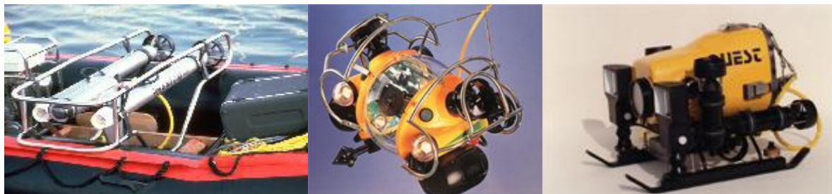
FIGURA 2: LCROV- EXEMPLOS DE ROV DE BAIXO CUSTO UTILIZADOS EM INSPEÇÕES E OBSERVAÇÕES SUBAQUÁTICAS.
