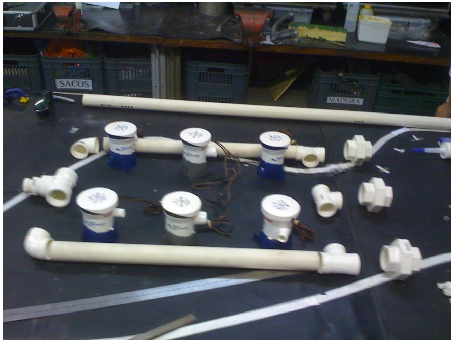
FIGURA 26: PRÉ-MONTAGEM DA PRIMEIRA VERSÃO DO ROV
