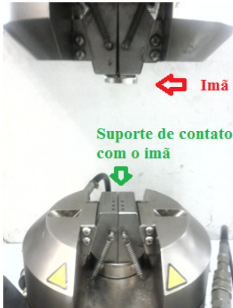
Figura 24 - Ensaio de Tração do Imã na Instron 8502
