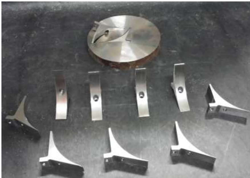
Figura 14 Peças feitas com o processo de eletroerosão a fio
