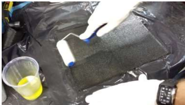
Figura 32 Fibra de carbono sendo banhada
