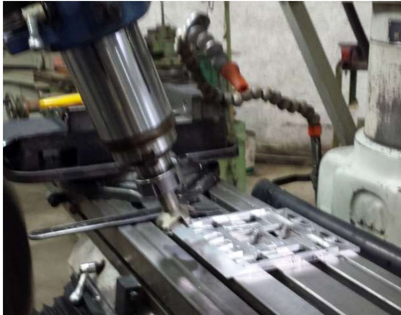
Figura 12 Chassi do C3D4 sendo fresado
