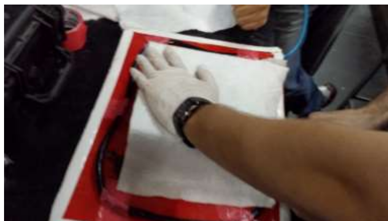
Figura 33 Feltro sendo colocado por cima da fibra de carbono
