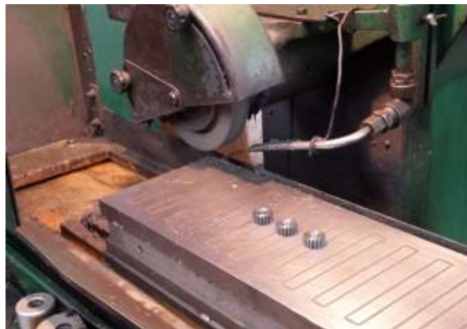
Figura 16 Engrenagens do C3D4 que foram retificadas
