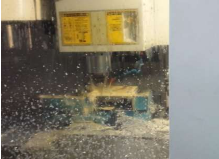
Figura 13 Chassi do C3D4 sendo usinado em um centro de usinagem CNC
