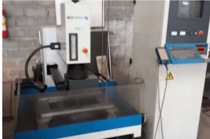
Figura 15 Equipamento de eletroerosão a fio onde foram cortadas peças do C3D4
