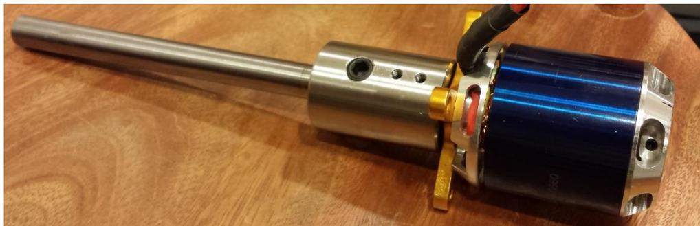
Figura 8 - Acoplador do eixo do motor no eixo principal, utilizando set screws M4 e M8
