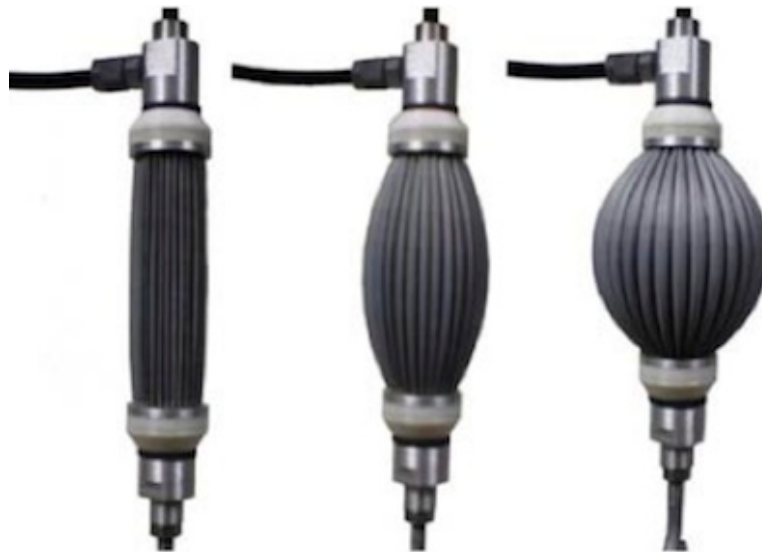
Figura 2.3: Estados de um PAM; relaxado, parcialmente contraído e completamente contraído, da esquerda para a direita.
