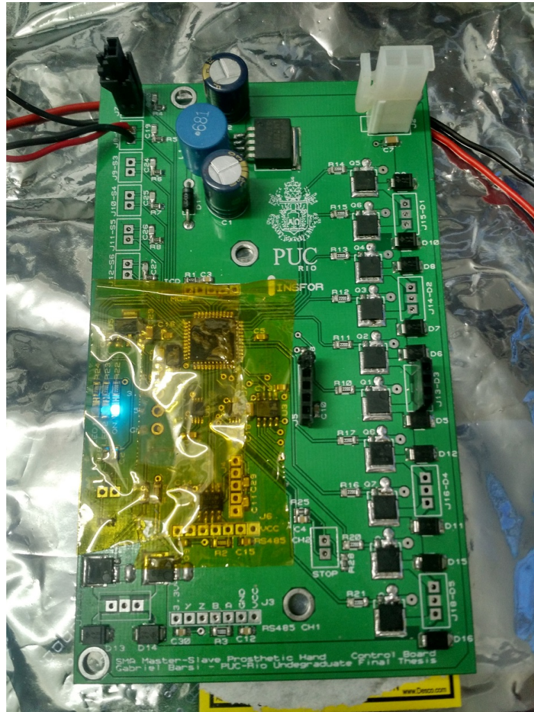
Figura 4.23: Placa de controle, material isolante térmico e elétrico protege a parte lógica.
