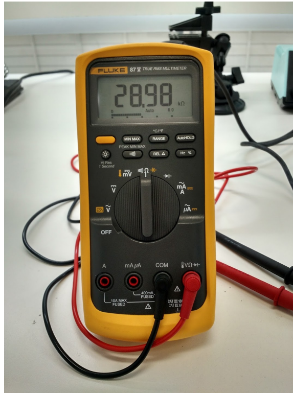
Figura 2.16: Multímetro Fluke 87V Industrial Multimeter configurado para medição de resistência em Ohms.
