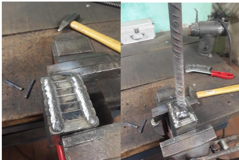
Fig.14 e 15: Soldagem das barrinhas e da haste para manuseio na forja.
