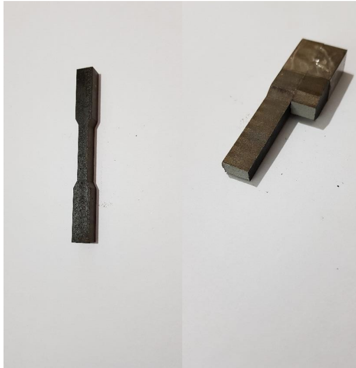
Fig.39 e 40: Corpo de prova comum antes e após o ensaio.
