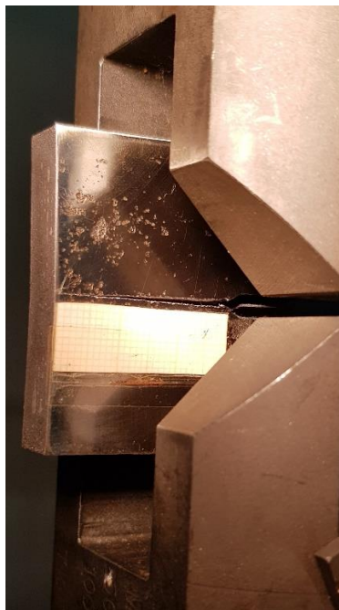
Fig.82: Corpo de prova no momento que se iniciou a trinca.
