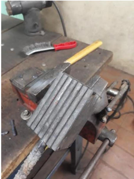
Fig. 16 e 17: Billet pronto e no forno para início do caldeamento.
