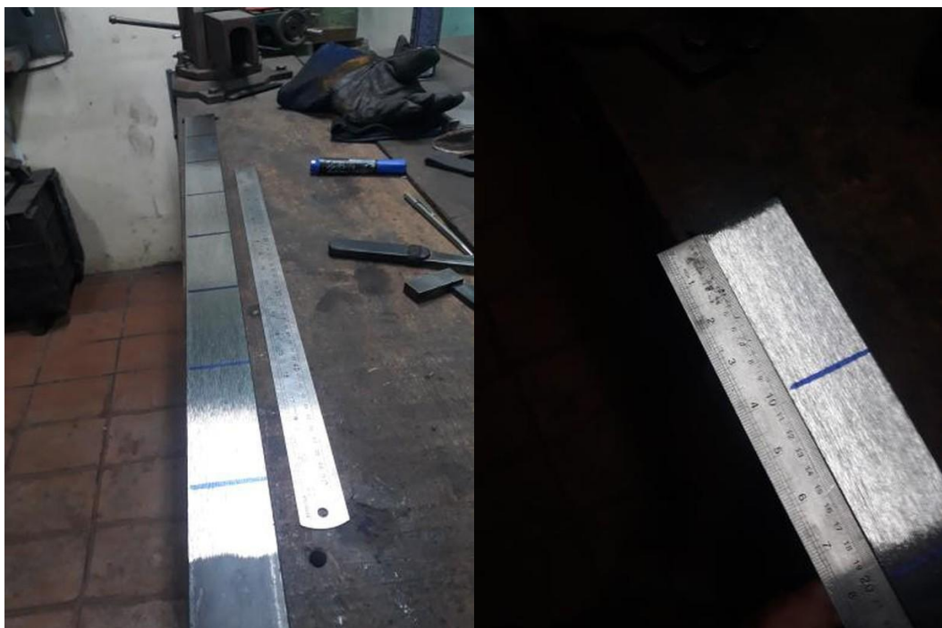
Fig.10 e 11: Imagens da barra com linhas de corte e medição de comprimento.
