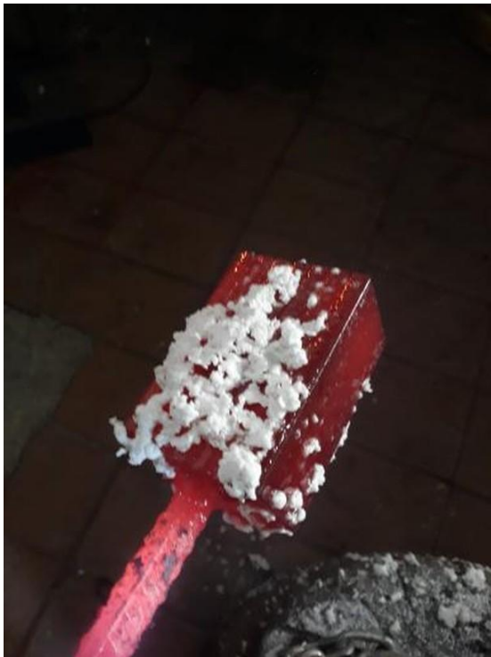
Fig.18 e 19: Bórax jogado para selar as barrinhas e Billet na prensa hidráulica para efetuar o caldeamento.
