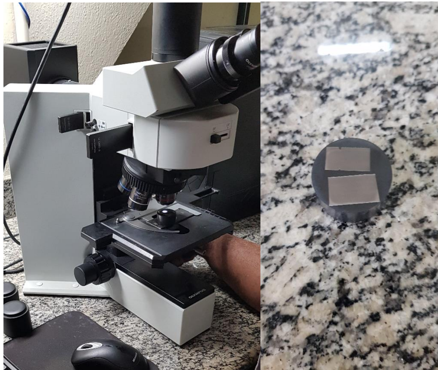
Fig.95 e 96: Microscópio utilizado e corpos de prova polidos para análise.
