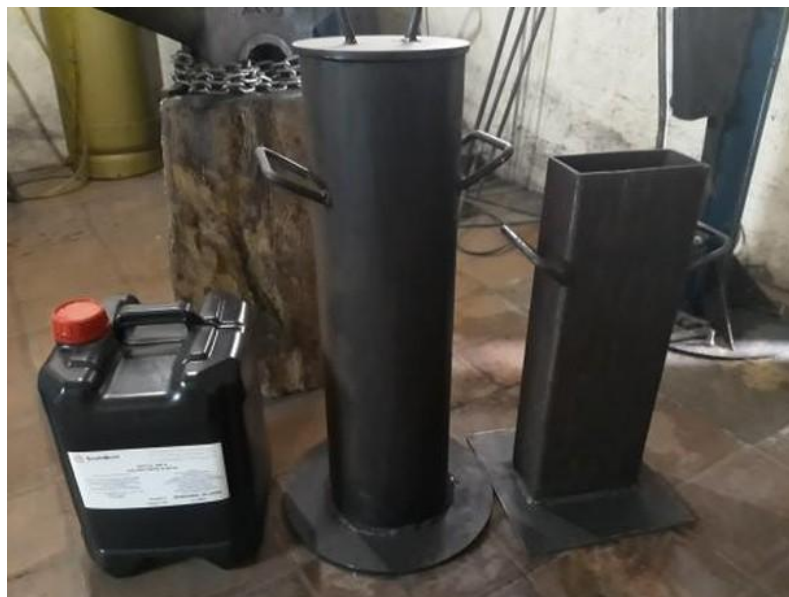
Fig.28: Recipiente e óleo utilizado para dar a têmpera.
