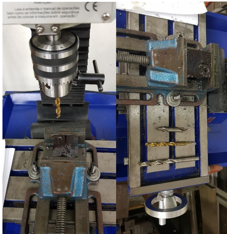
Fig.72 e 73: Fresadora após aplicação do furo e brocas utilizadas.
