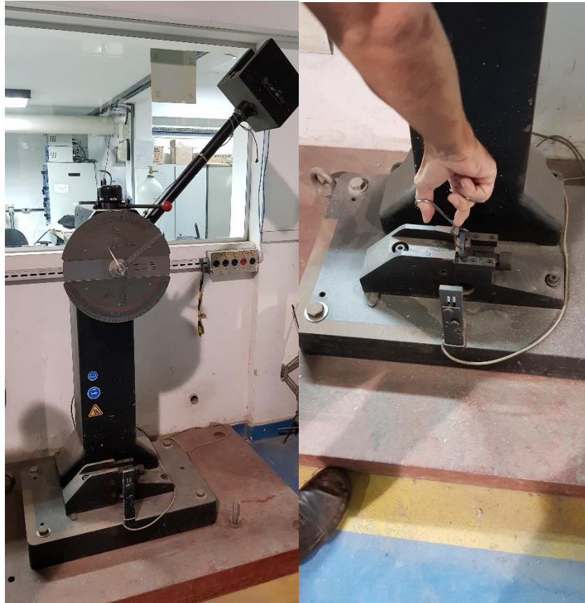
Fig.59 e 60: Imagem da máquina utilizada e do corpo de prova sendo inserido na posição correta através de um “pegador” específico para este ensaio.
