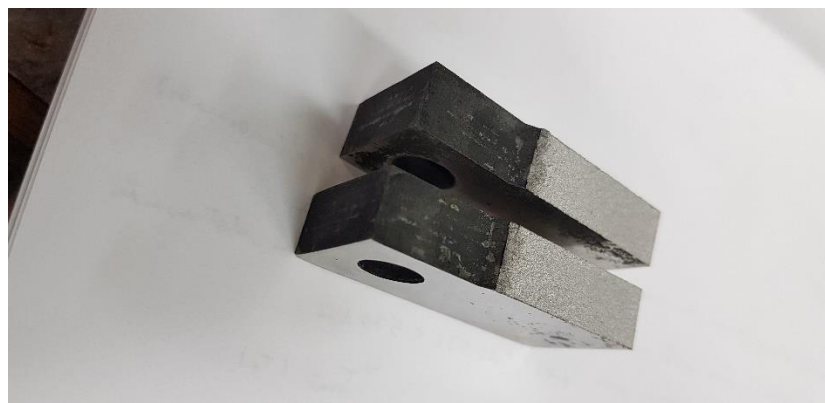
Fig.84: Corpo de prova caldeado rompido completamente.
