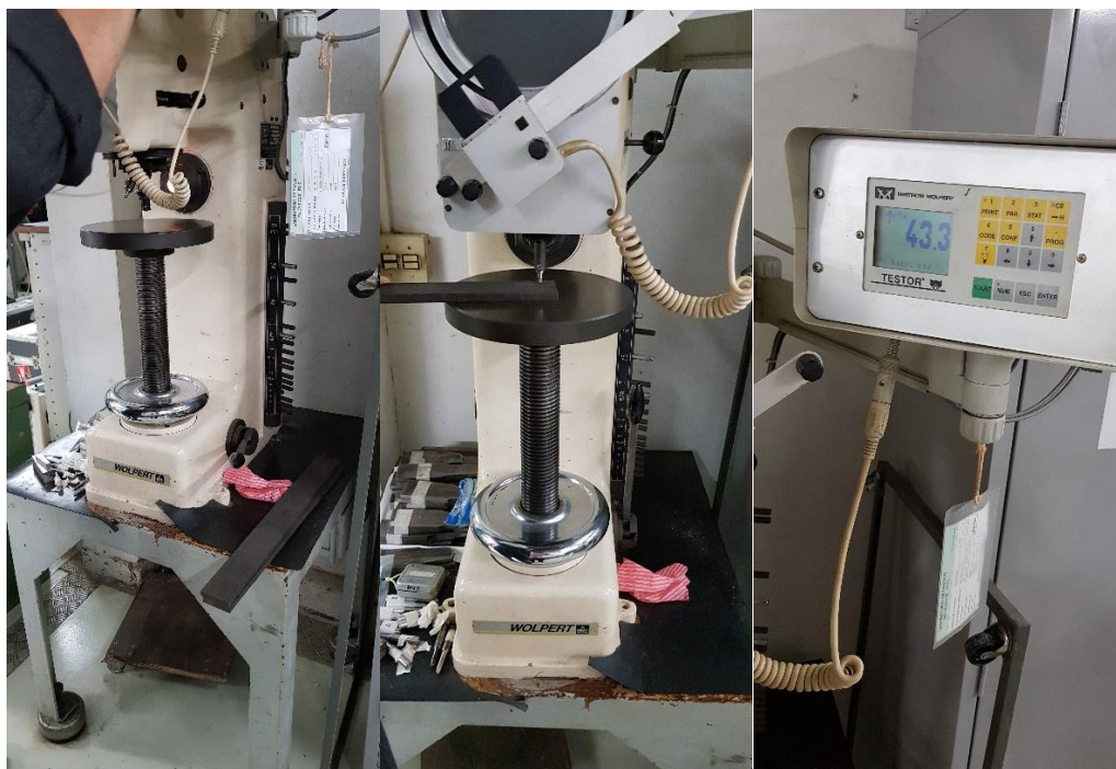
Fig.32, 33 e 34: Imagens do ensaio de dureza Rockwell C.
