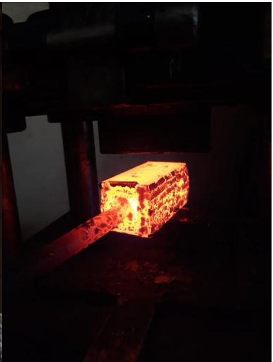
Fig.18 e 19: Bórax jogado para selar as barrinhas e Billet na prensa hidráulica para efetuar o caldeamento.
