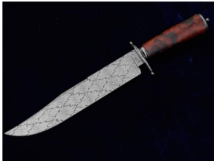
Fig.9: Imagem de uma faca em aço damasco com desenhos específicos e controlados em formato de um mosaico - @joeliton_satiuq.
