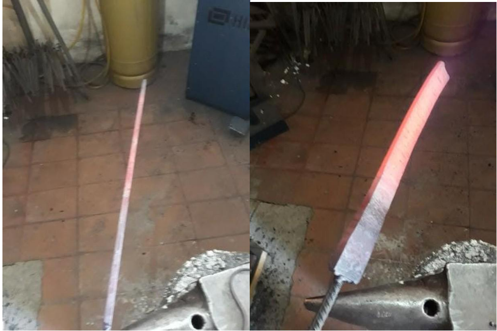
Fig. 24 e 25: Barra uniformemente esticada e após dobrada e caldeada, sendo esticada novamente para o tamanho final.
