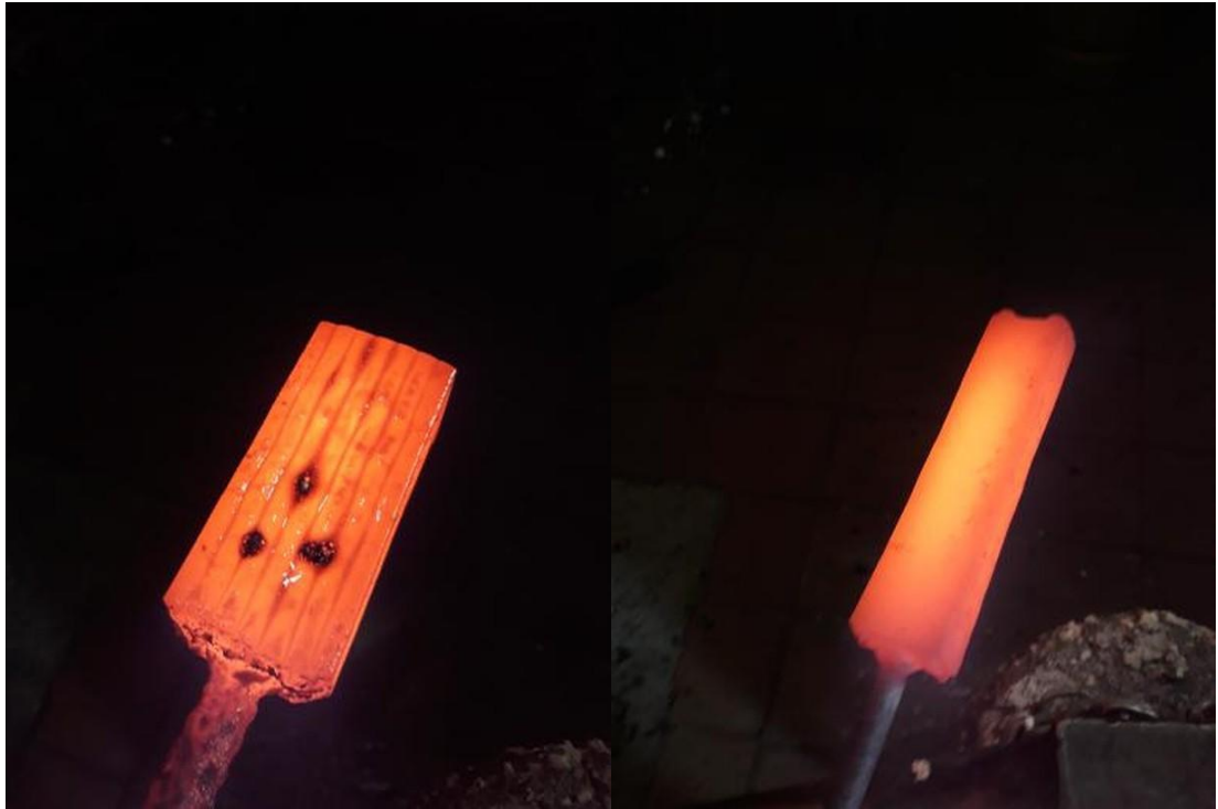
Fig.20 e 21: Barras quase e já fundidas.
