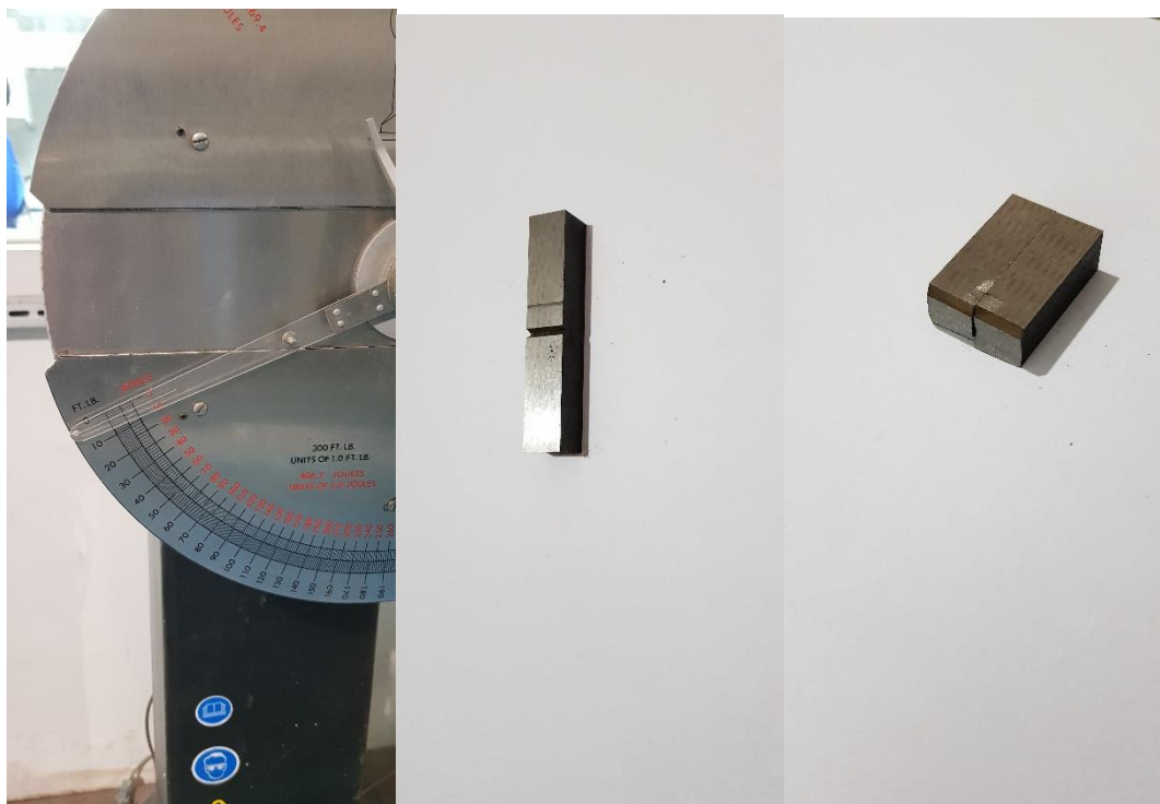
Fig.61, 62 e 63: Resultado de um dos ensaios e o corpo de prova antes e depois do impacto, totalmente frágil.
