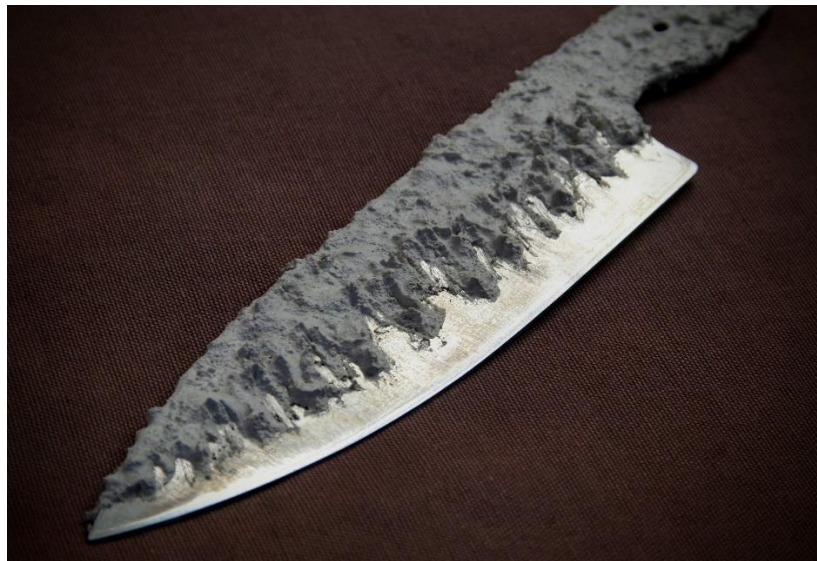
Fig.8: Ilustração de uma faca com seu dorso revestido para deixá-lo mais tenaz
