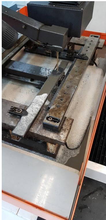
Fig.31: Máquina usada para fazer a usinagem a frio por eletroerosão.
