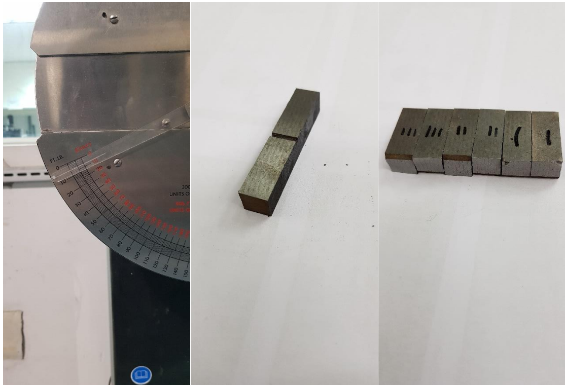
Fig.64, 65 e 66: Resultado de um dos ensaios e o corpo de prova antes e depois do impacto, totalmente frágil.
