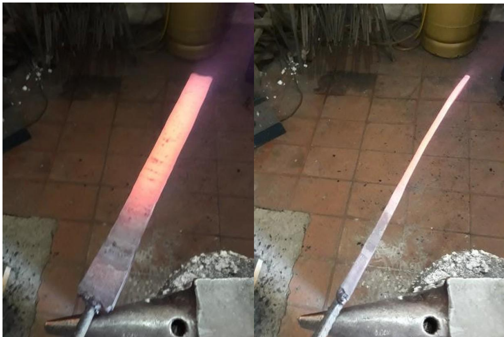
Fig. 22 e 23: Esticamento da barra para efetuar um novo dobramento.
