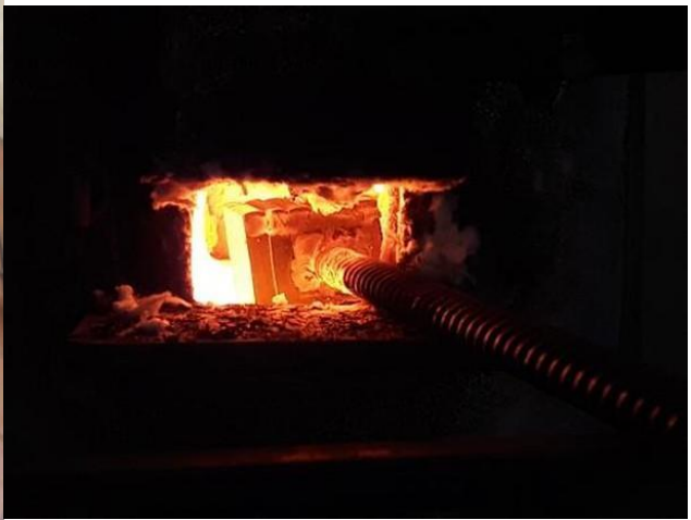
Fig. 16 e 17: Billet pronto e no forno para início do caldeamento.
