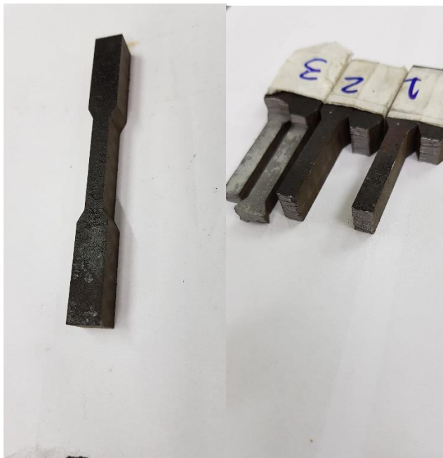
Fig.45 e 46: Corpo de prova caldeado antes e após o ensaio.
