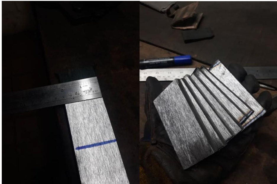
Fig.12 e 13: Medição da largura e corte pedaços da barra já cortados.
