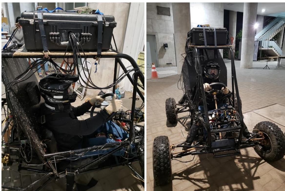
Figura 5.19 – Carro equipado e com piloto, pronto para a realização dos testes
