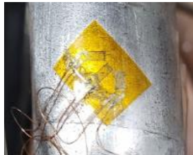
Figura 5.9 – Exemplo de roseta posicionada na superfície de um tubo
