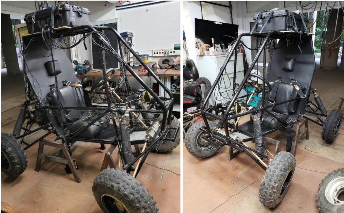
Figura 5.17 – Veículo erguido por cavaletes para a realização da calibração
